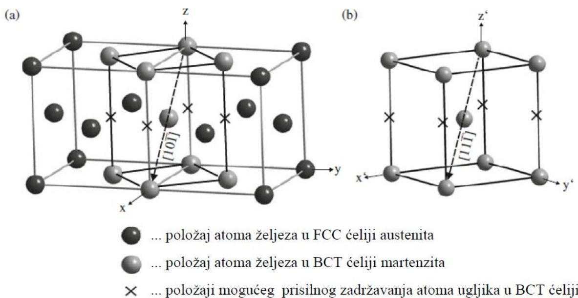
SLIKA 11. Nastanak kristalne rešetke martenzita mehanizmom Bainove deformacije[10]
