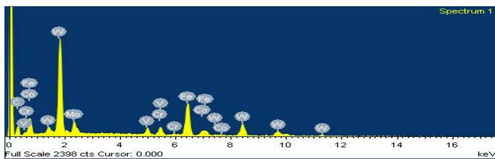
SLIKA 48. EDS analiza karbida tipa M<sub>6</sub>C na metalografskom uzorku od čelika PM S390 MC (kaljeno 1130<sup>0</sup>C/dušik i popušteno 550<sup>0</sup>C/2h/zrak) (uzorak 1AC)
