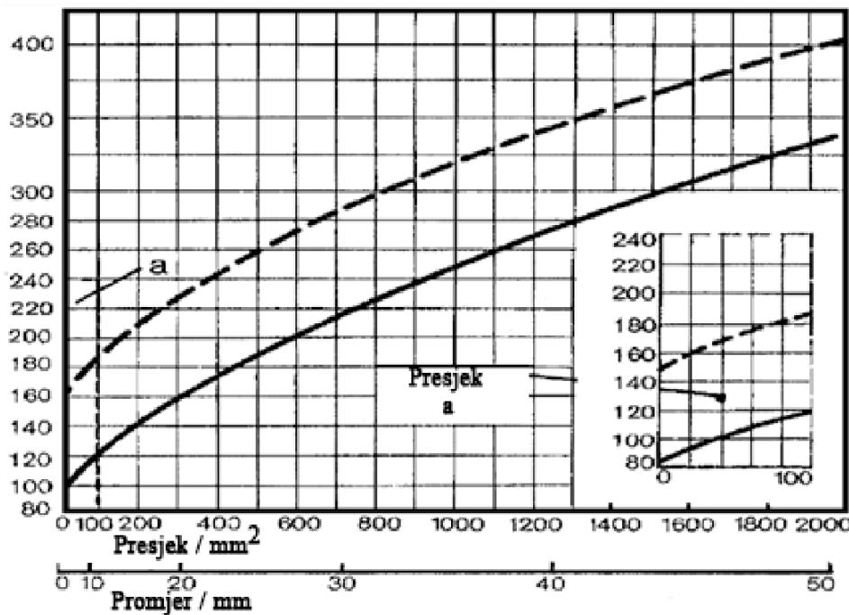
SLIKA 7. Vrijeme uranjanja u kupku za austenitiziranje u zavisnosti od presjeka alata od
