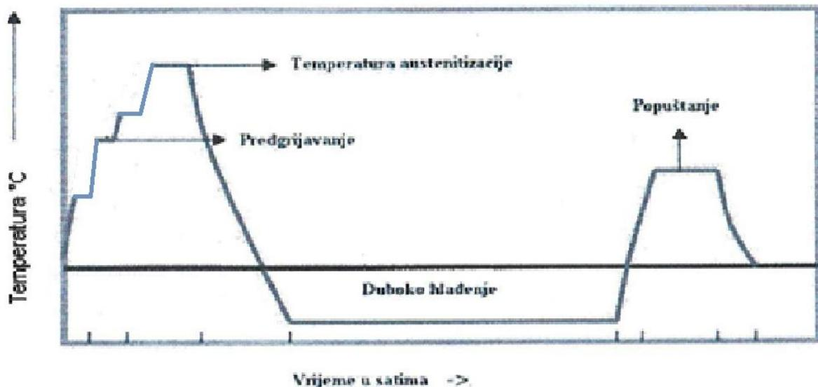
SLIKA 6. Suvremenih postupak kaljenja, dubokog hlađenja i popuštanja brzoreznih čelika[8]
