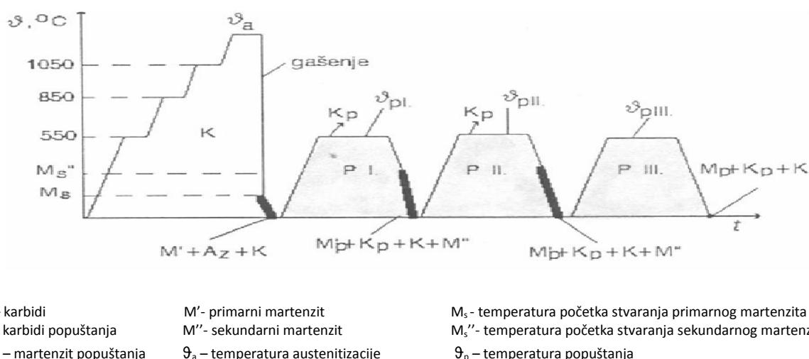
SLIKA 5. Konvencionalni postupak kaljenja i popuštanja brzoreznih čelika[7]
