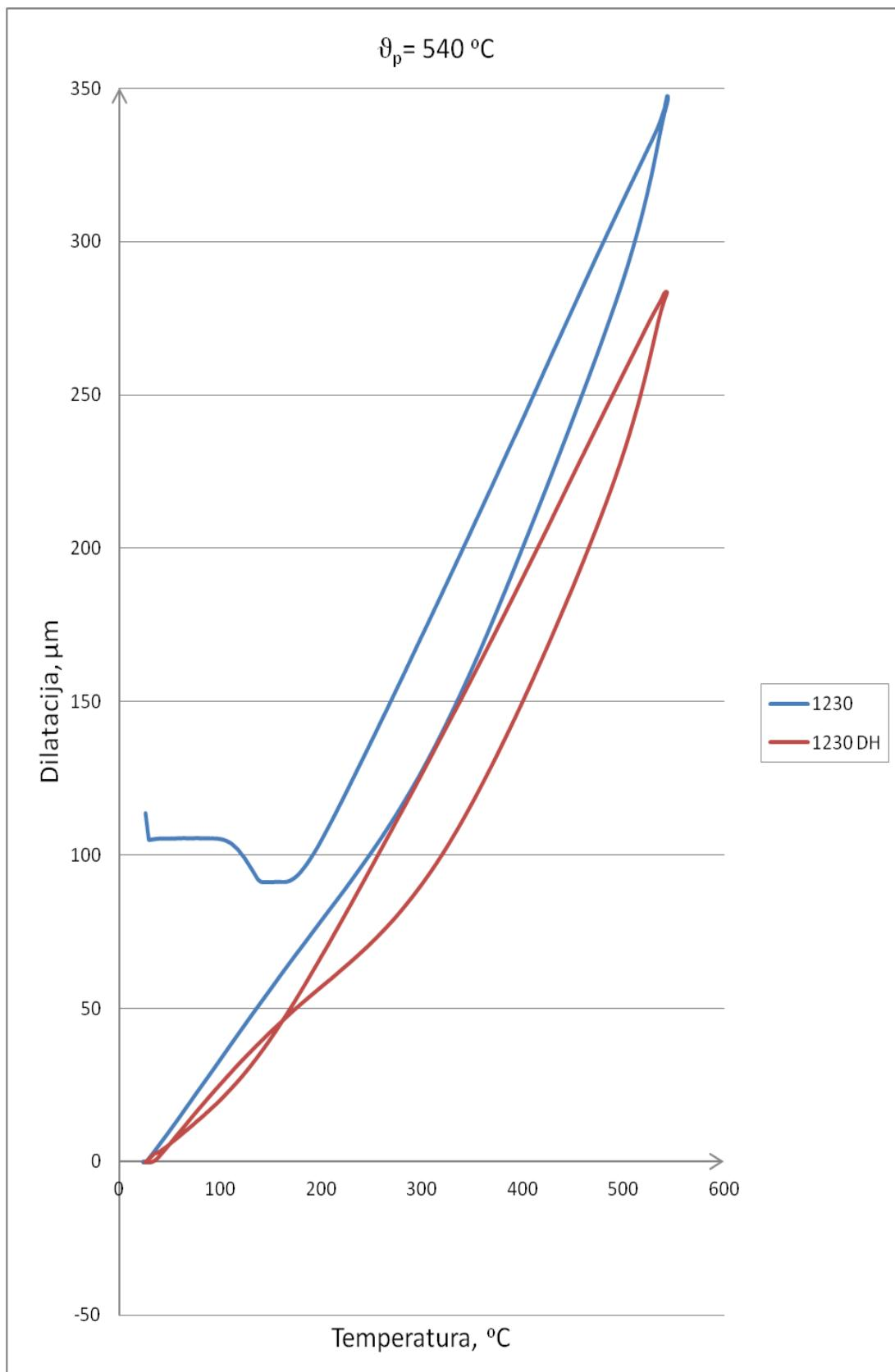
SLIKA 40. Dilatogram popuštanja za ispitne uzorke od čelika PM S390MC gašenih s temperature austenitizacije  $1230\text{ }^{\circ}\text{C}$  u struji dušika
