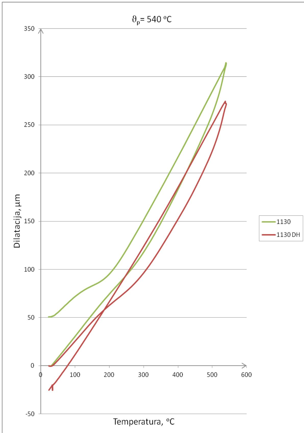
SLIKA 38. Dilatogram popuštanja za ispitne uzorke od čelika PM S390MC gašenih s temperature austenitizacije  $1130\text{ }^{\circ}\text{C}$  u struji dušika
