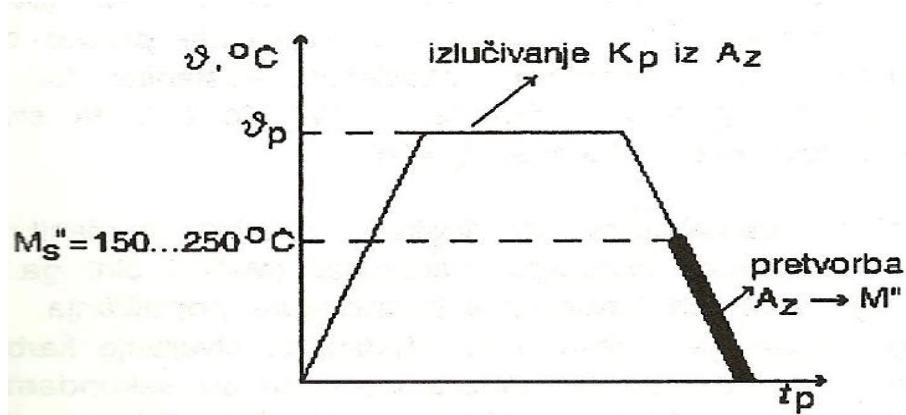
SLIKA 14. Mikrostrukturni procesi pri visokotemperaturnom popuštanju brzoreznog čelika[2]
