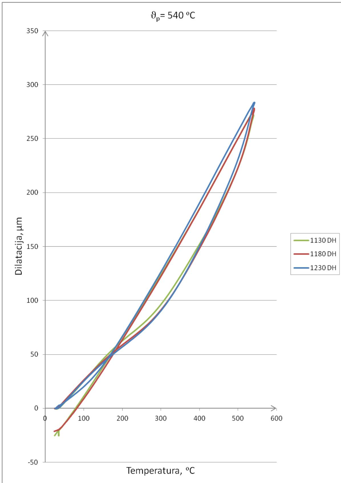
SLIKA 42. Dilatogram popuštanja za duboko hlađene ispitne uzorke od čelika PM S390MC
