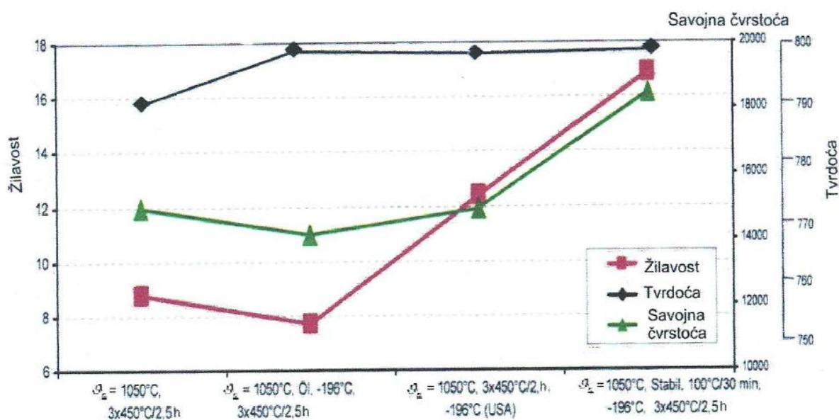
SLIKA 30. Usporedba mehaničkih svojstava čelika K 190 dobivenih klasičnim postupkom toplinske obrade te različitim postupcima dubokog hlađenja[25]
