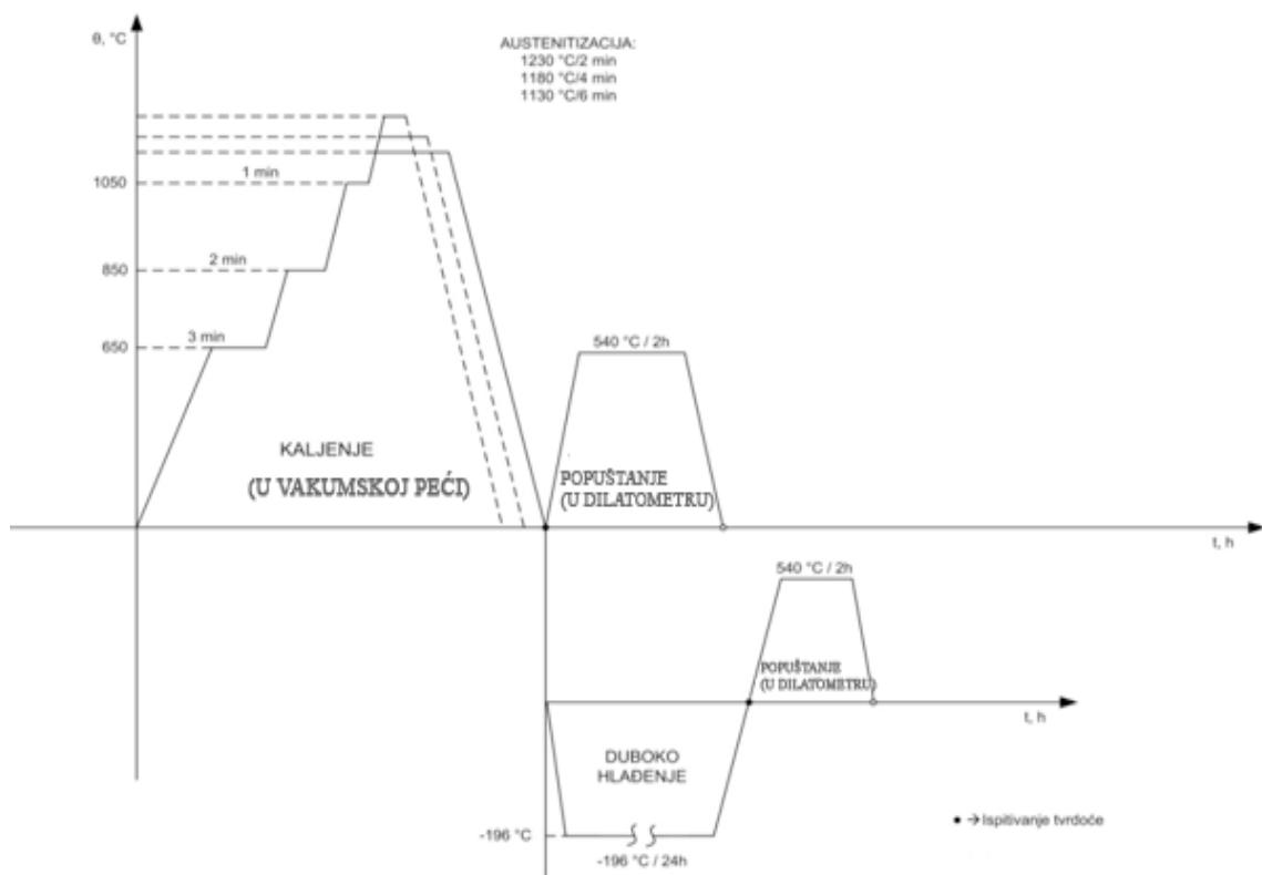
SLIKA 34. Dijagram toplinske obrade ispitnih uzoraka za snimanje dilatometričkih krivulja čelika PMS390 MC
