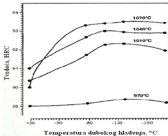
SLIKA 16. Utjecaj temperatura dubokog hlađenja i austenitizacije na tvrdoću alatnog čelika X160CrMoV121 (Č4850, AISI D2) (Svi uzorci držani su 30 minuta na temperaturama austenitizacije i popuštani na  $200^{\circ}\text{C}/1\text{sat}$ )[21]
