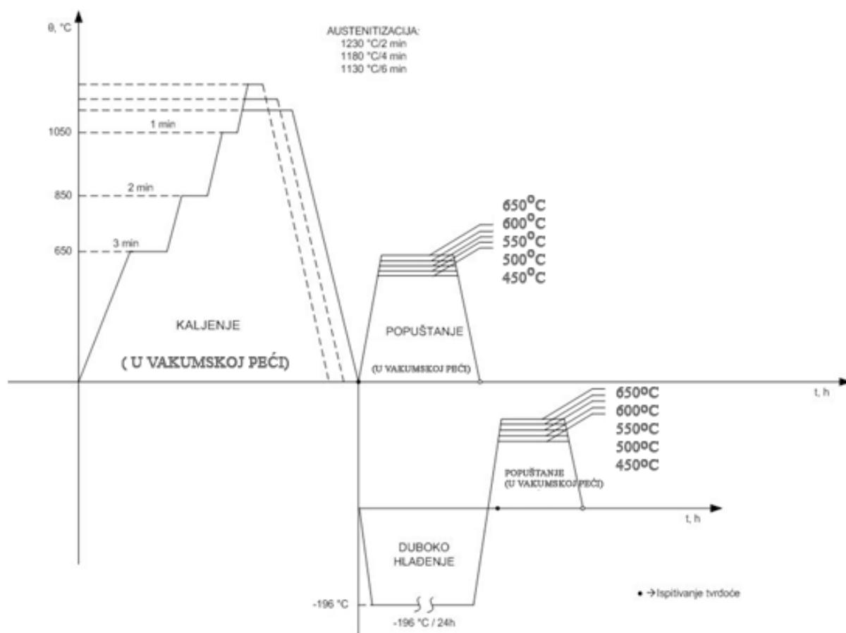
SLIKA 33. Dijagram toplinske obrade ispitnih uzoraka za snimanje dijagrama popuštanja čelika
