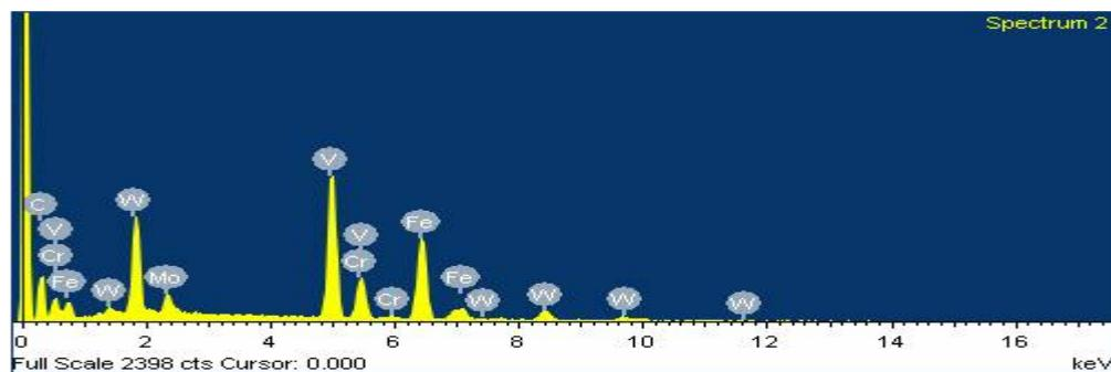
SLIKA 49. EDS analiza karbida tipa MC na metalografskom uzorku od čelika PM S390 MC (kaljeno 1130<sup>0</sup>C/dušik i popušteno 550<sup>0</sup>C/2h/zrak) (uzorak 1AC)
