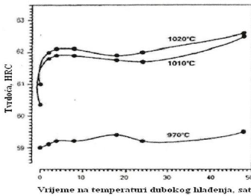
SLIKA 17. Utjecaj vremena držanja i temperature austenitizacije na tvrdoću alatnog čelika X160CrMoV121 (Č4850, AISI D2) (Svi uzorci držani su 30 minuta na temperaturama austenitizacije i popuštani na 200°C/1sat)[21]
