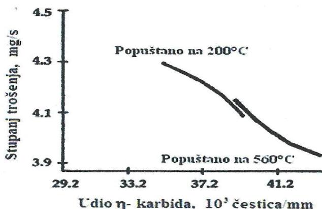
SLIKA 19. Utjecaj količine  $\eta$ -karbida na otpornost prema trošenju za čelik X160CrMoV121 (AISI D2, C4850)(kaljeno  $1075\text{ }^{\circ}\text{C}$ /zrak/ duboko hlađeno  $-196\text{ }^{\circ}\text{C}$ )[8]
