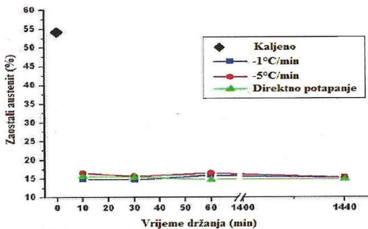
SLIKA 21. Udjeli zaostalog austenita kod kaljenog i kaljenog pa potom duboko hlađenog alatnog čelika X160CrMoV121 u ovisnosti o načinu hlađenja i vremenu držanja na temperaturama dubokog hlađenja[22]
