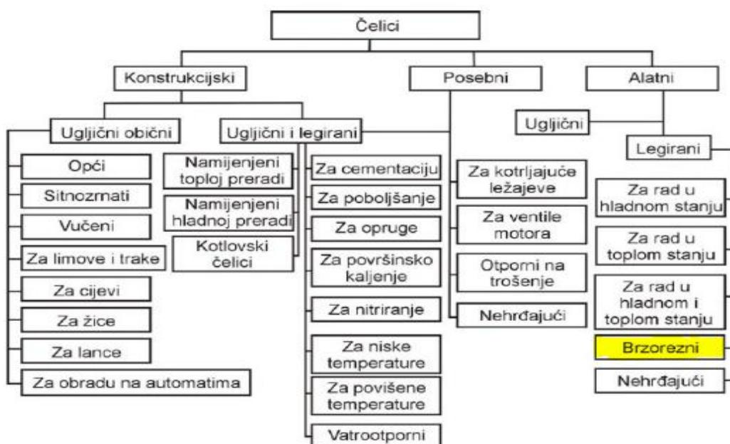
SLIKA 1. Sistematisacija čelika prema namjeni[1]
