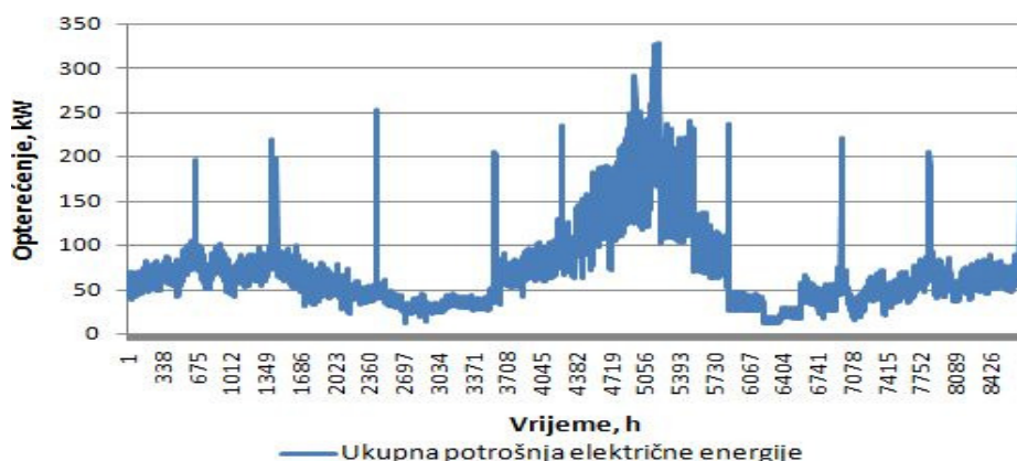
Dijagram 34. Konačni oblik krivulje satnog opterećenja električne energije
