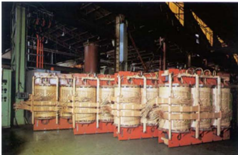
Slika 3. Energetski transformatori – jezgre s namotima
