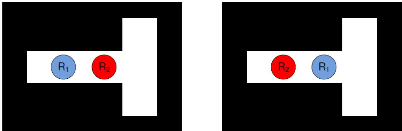
Slika 1.2 Primjer početne (lijevo) i konačne (desno) konfiguracije za koje decentralizirani pristup ne daje zadovoljavajuće rješenje
