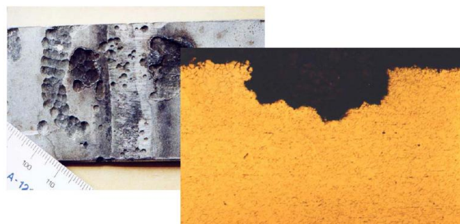
Slika 3. Razaranja materijala pjegastom korozijom [4]
