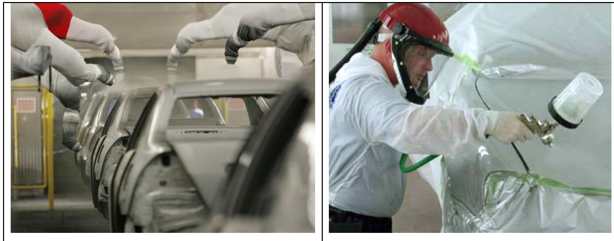
Slika 27. Nanošenje vodorazrjeđivih premaza u automobilskoj industriji [16, 17]
