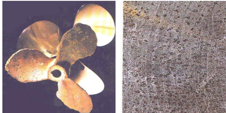
Slika 8. Decinkacija mjedi i grafitizacija sivog lijeva [4]
