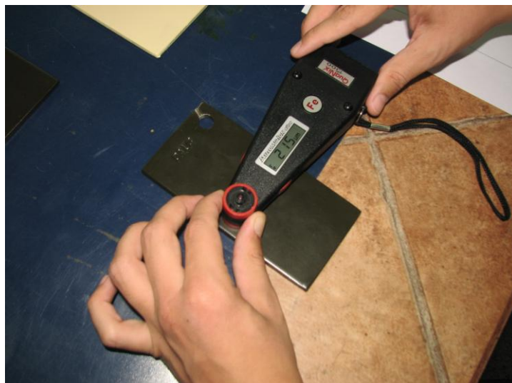
Slika 34. Mjerenje debljine prevlake [20]
