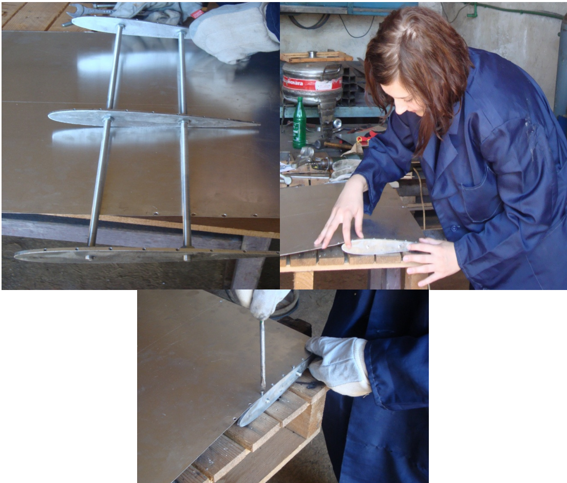
Slika 4. a) Izgled unutarnje konstrukcije krila, b) savijanje oplata preko rebara, c) pričvršćivanje oplata pomoću vijaka
