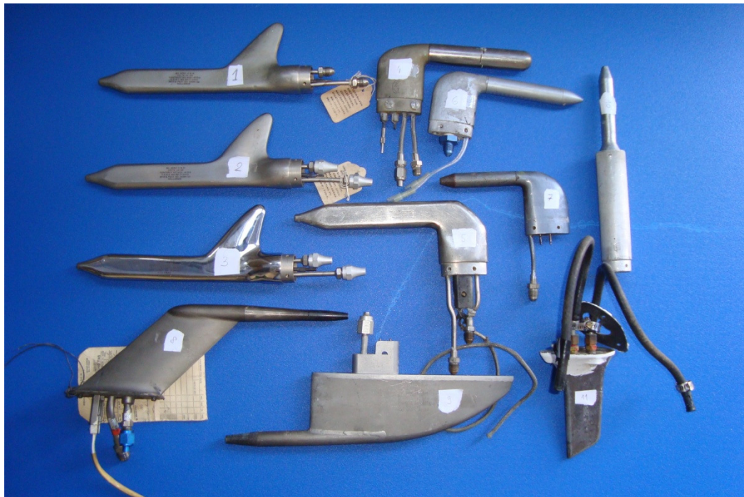
Slika 5-1 Pitot-statičke cijevi korištene pri mjerenjima
