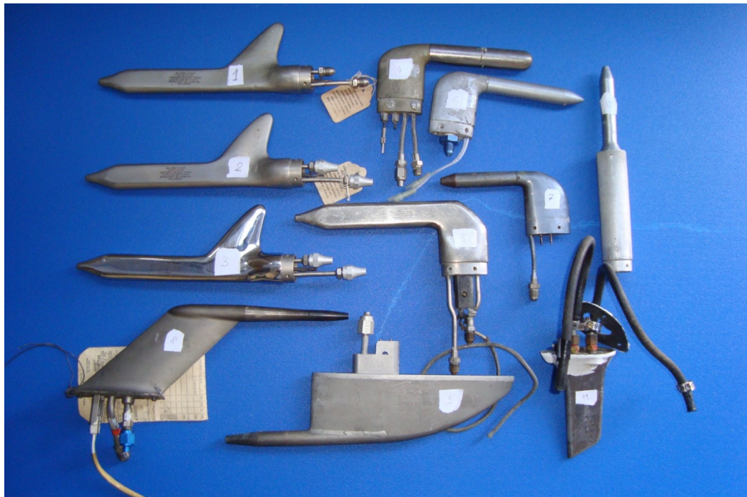
Slika 5-1 Pitot-statičke cijevi korištene pri mjerenjima
