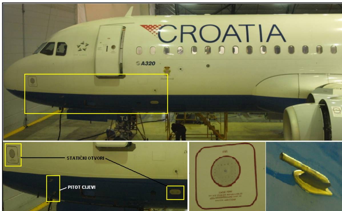
Slika 1-3 Pitot-statički sustav zrakoplova A320
