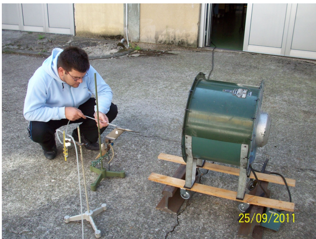
Slika 6-1 Karakterizacija strujanja oko Pitot-statičkih cijevi
