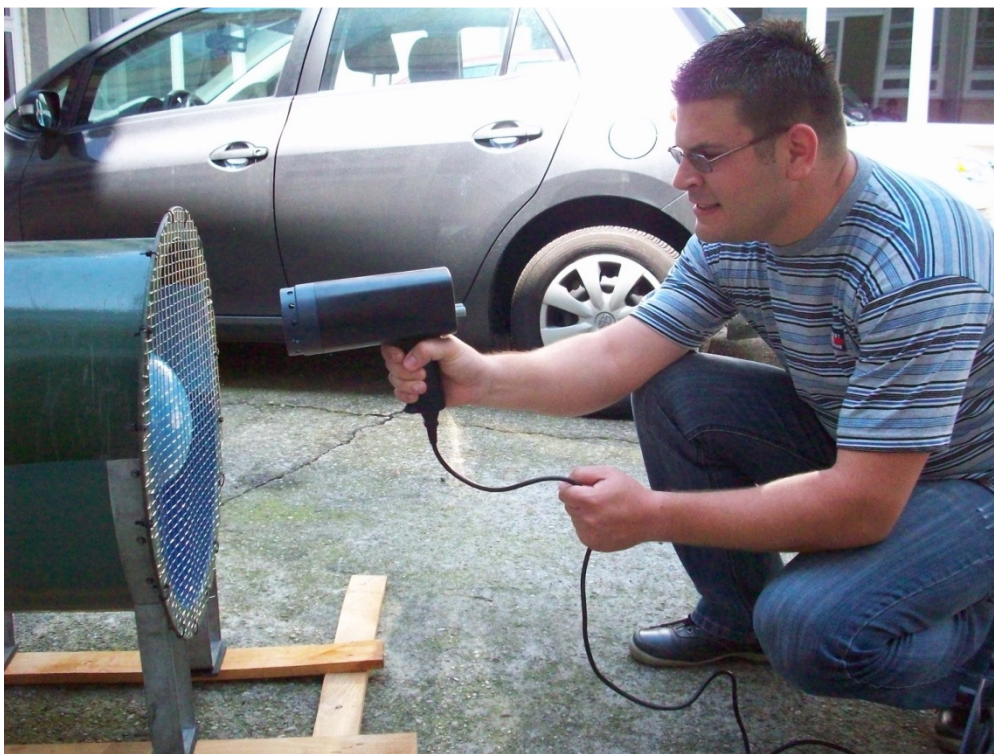
Slika 4-2 Mjerenje broja okretaja ventilatora stroboskopom
