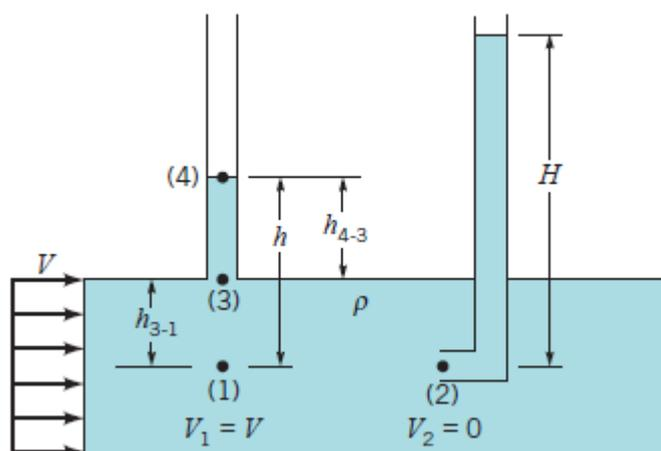
Slika 2-3 Mjerenje statičkog i ukupnog tlaka [7]
