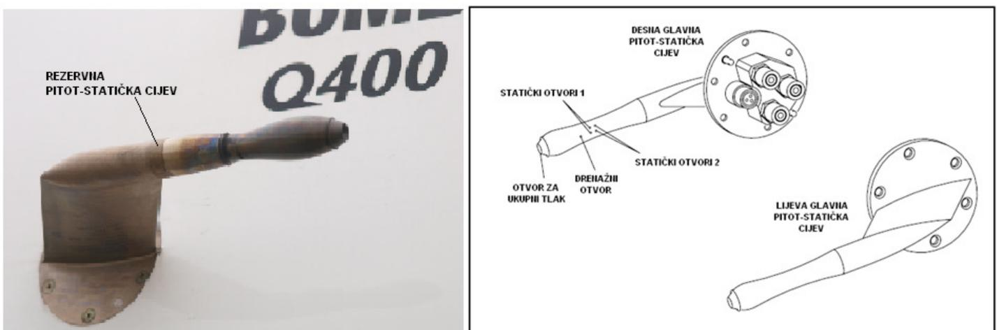
Slika 1-2 Pitot-statičke cijevi na zrakoplovu Dash Q400 [3]
