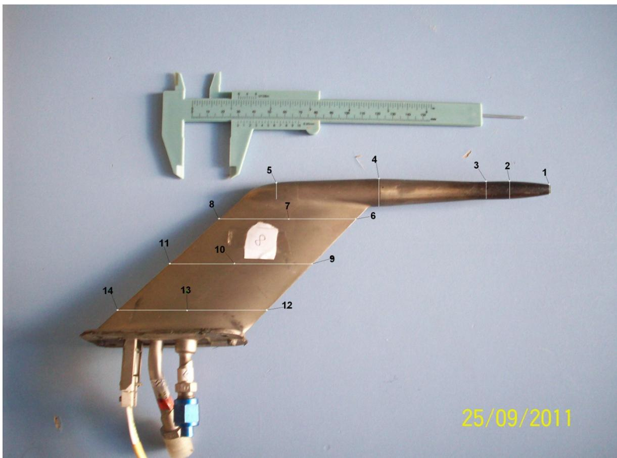
Slika 6-3 PS-8 sa označenim pozicijama za mjerenje tlaka
