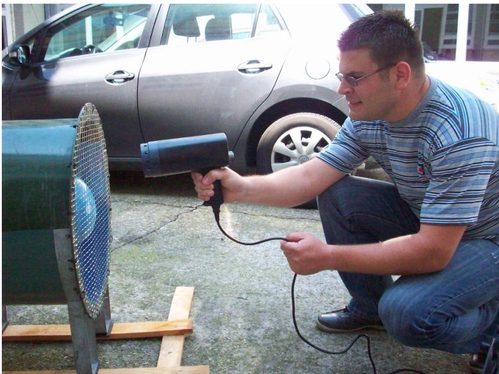
Slika 4-2 Mjerenje broja okretaja ventilatora stroboskopom
