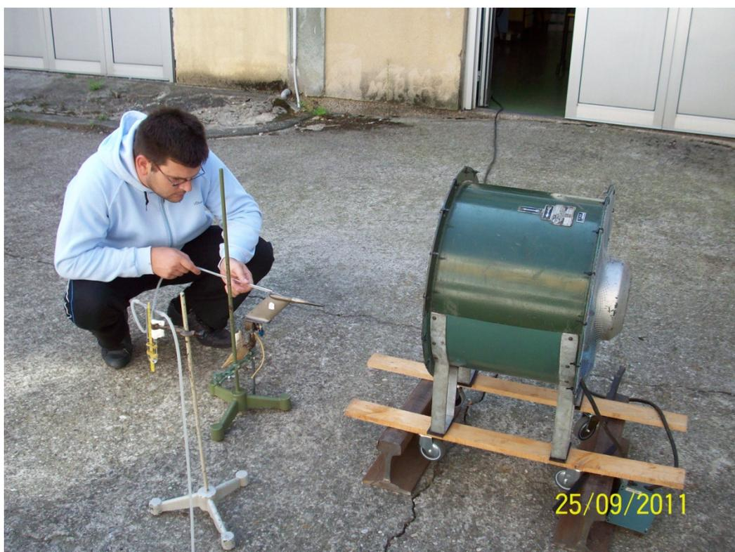
Slika 6-1 Karakterizacija strujanja oko Pitot-statičkih cijevi
