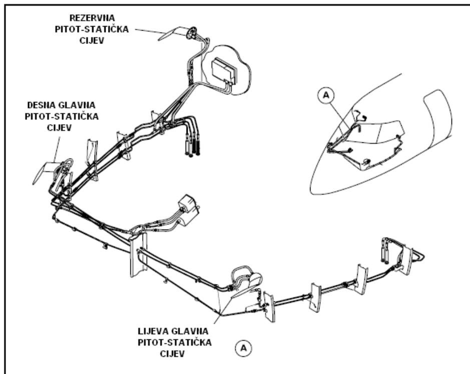
Slika 1-1 Pitot-statički sustav na zrakoplovu Dash Q400 [3]
