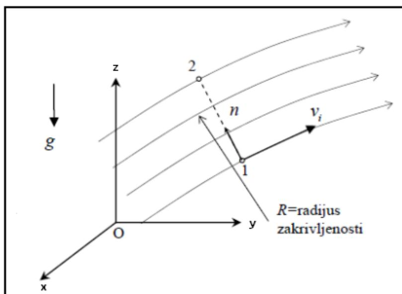
Slika 2-1 Promjena tlaka okomito na strujnice [6]
