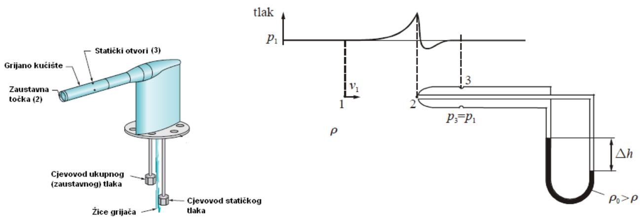
Slika 2-4 Pitot – statička cijev [6], [7]
