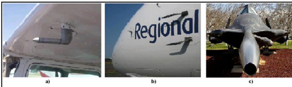
Slika 1-5 Pitot cijevi za različite brzine letenja: a) zrakoplov generalne avijacije, b) komercijalni putnički zrakoplov i c) nadzvučni borbeni zrakoplov (slike preuzete sa [www.airliners.net](http://www.airliners.net))
