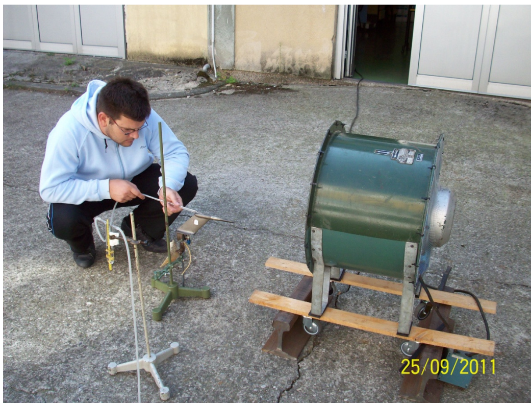
Slika 6-1 Karakterizacija strujanja oko Pitot-statičkih cijevi
