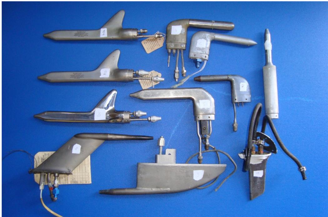
Slika 5-1 Pitot-statičke cijevi korištene pri mjerenjima
