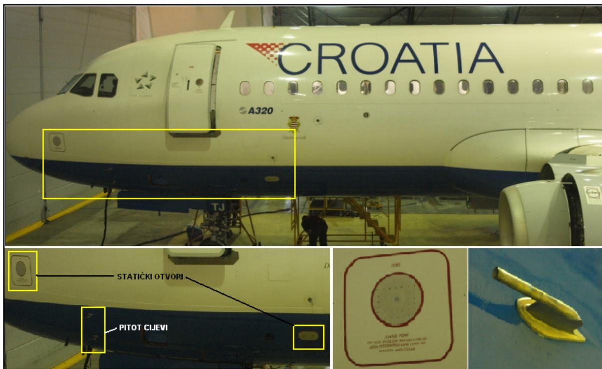
Slika 1-3 Pitot-statički sustav zrakoplova A320
