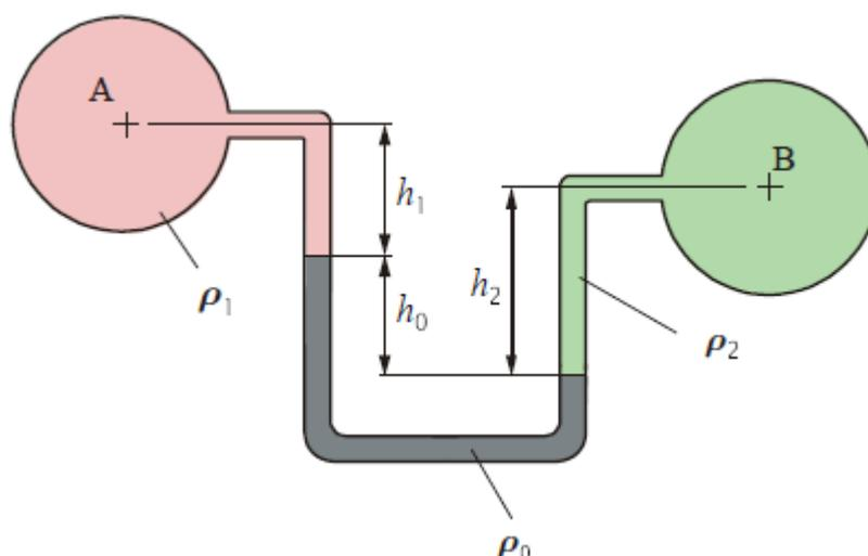
Slika 2-2 Diferencijalni manometar [6]
