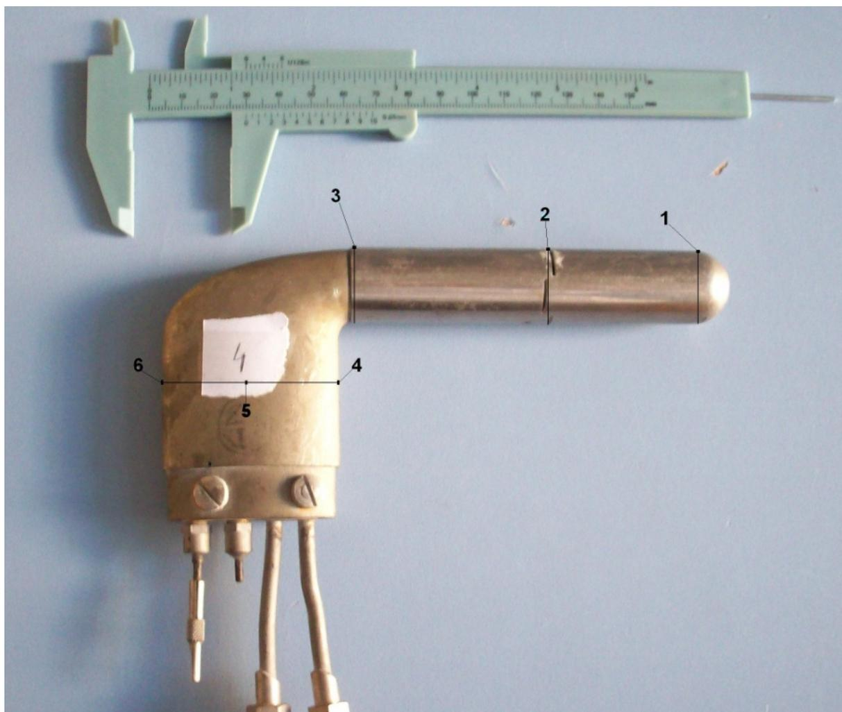
Slika 6-2 PS-4 sa označenim pozicijama za mjerenje tlaka
