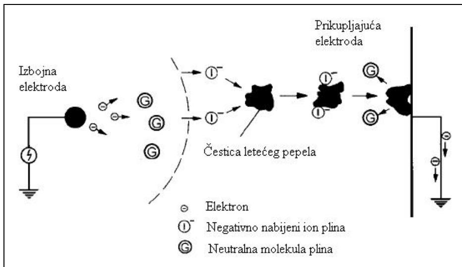
Slika 14. Mehanizam otprašivanja u elektrostatičkom otprašivaču [12]
