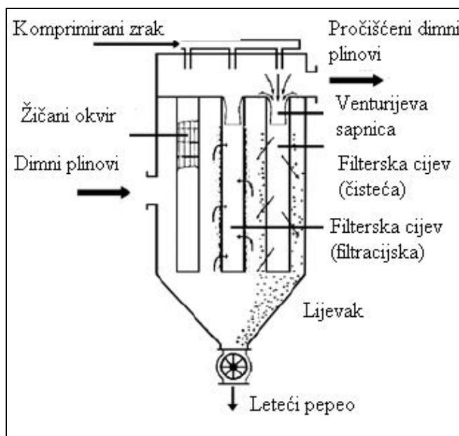
Slika 15. Vrećasti filter sa sustavom komprimiranog zraka [12]
