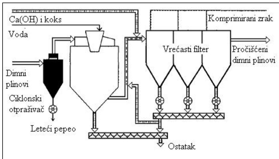
Slika 17. Sustav suhog čišćenja dimnih plinova [12]
