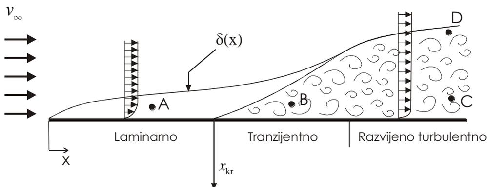
**Slika 6. Shematski prikaz graničnog sloja uz ravnu ploču**
