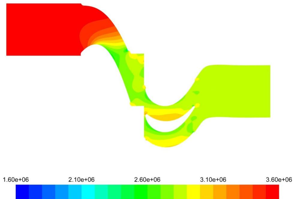
Slika 28. Polje tlaka (Pa) – aksijalni zazor 2 mm – 3D simulacija
