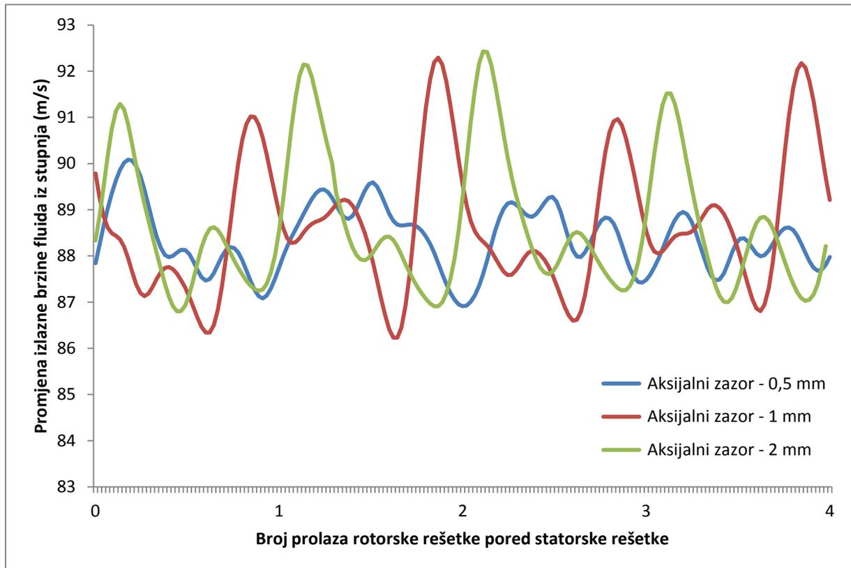
Slika 32. Promjena izlazne brzine u vremenu – 3D simulacija
