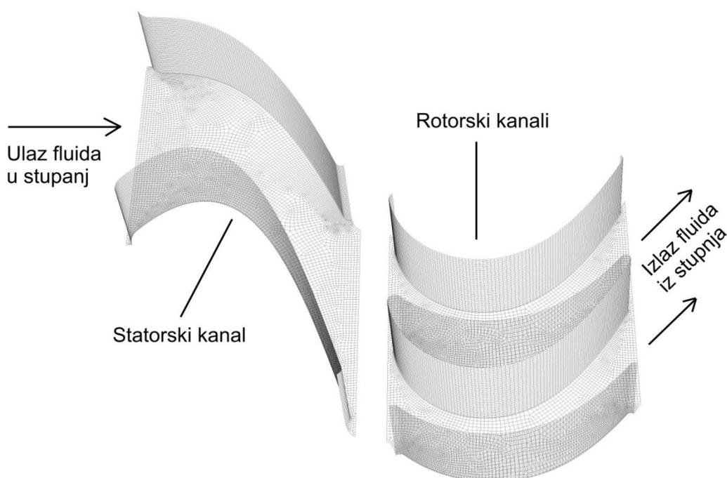
**Slika 20. 3D geometrija prvog stupnja mini plinske turbine**
