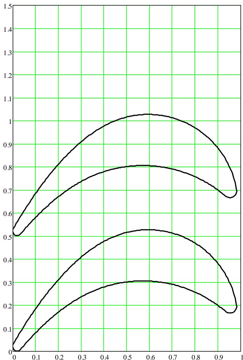
**Slika 4. Rotorska rešetka prvog stupnja mini plinske turbine**
