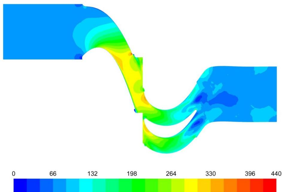
**Slika 21.** Polje brzine (m/s) – aksijalni zazor 1 mm – 3D simulacija
