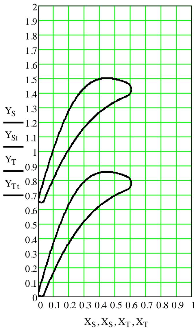
**Slika 2. Statorska rešetka prvog stupnja mini plinske turbine**
