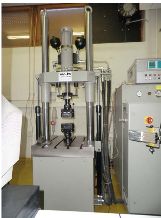
Slika 7.5 Servohidraulička kidalica WALTER+BAI AG
