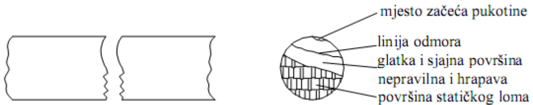
Slika 3.3 Opći izgled površine loma usljed umora materijala
