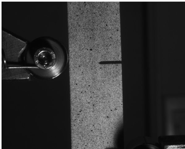
Slika 7.13 Raster za stereometrijsko 3D mjerenje
