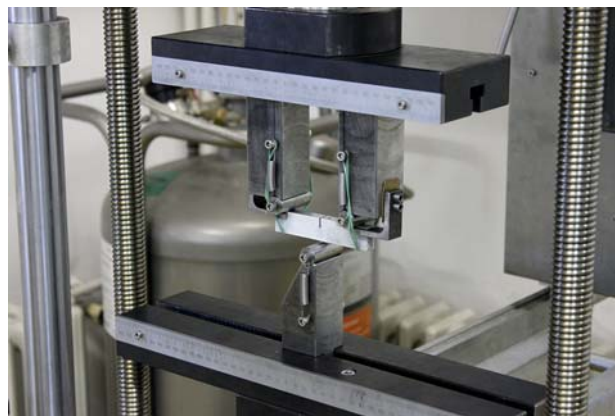
Slika 7.16 Uređaj za savijanje u tri točke
