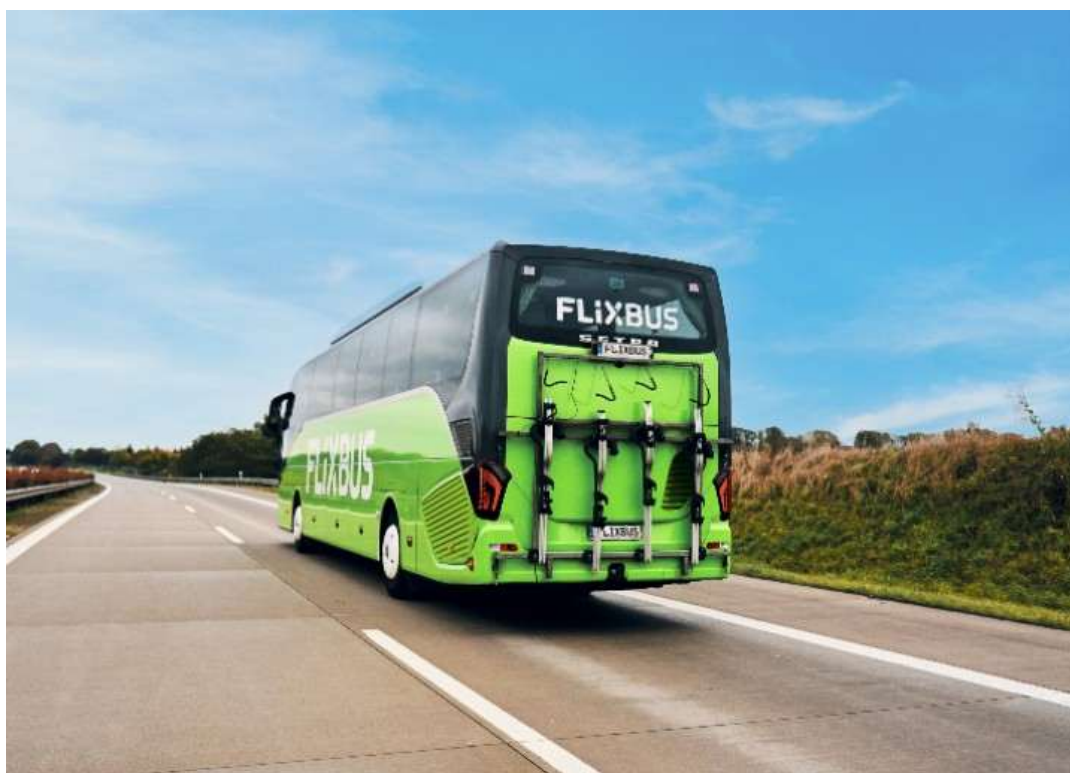
Slika 5. Nosač s sustavom za pritezanje okvira bicikla [7]
