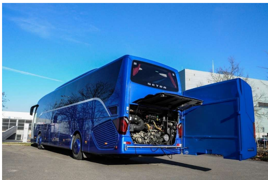
Slika 7. Prikaz mehanizma za omogućavanje pristupa motoru [9]
