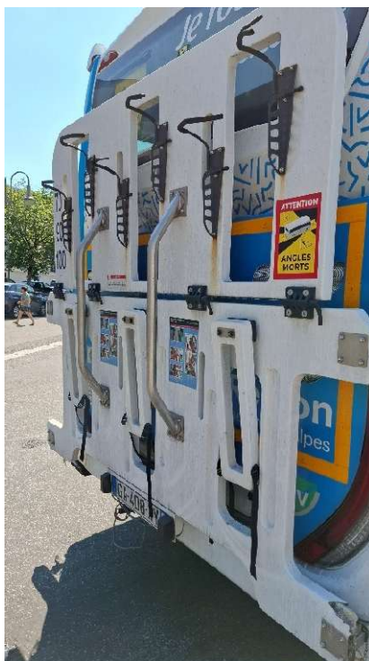
Slika 4. Nosač od sendvič konstrukcije
