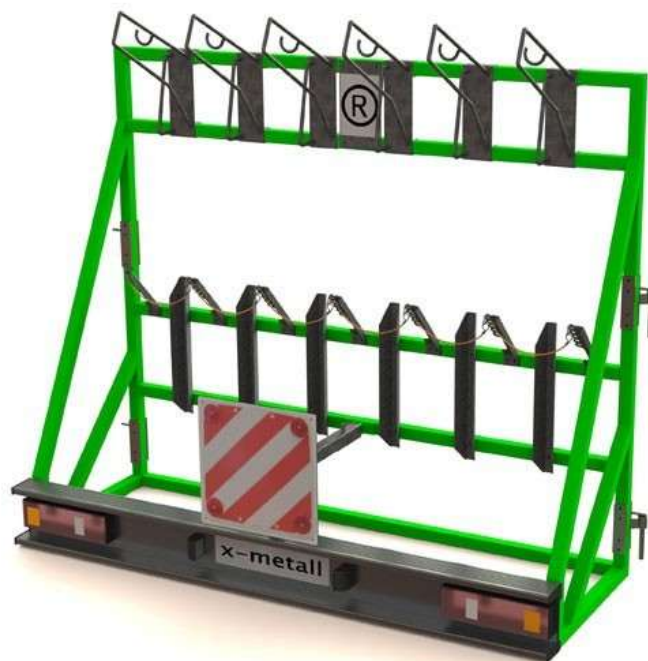
Slika 3. Nosač za 6 bicikala s integriranom svjetlosno signalnom opremom [6]
