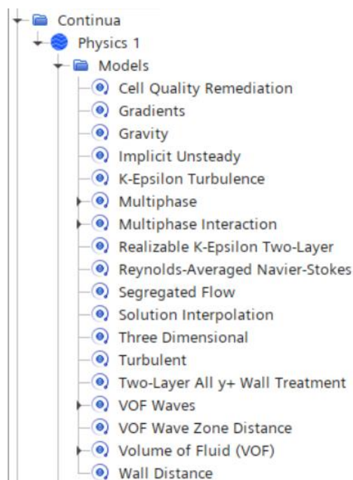
Slika 13: Odabrani fizikalni model numeričke simulacije
