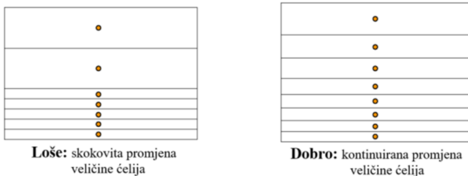
Slika 9: Primjer dobrog i lošeg diskretiziranja graničnog sloja
