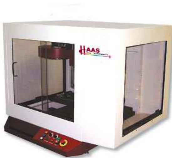
Slika 2.5. Četvero-osna stanica za lasersko mikrooblikovanje tvrtke HAAS. [13]
