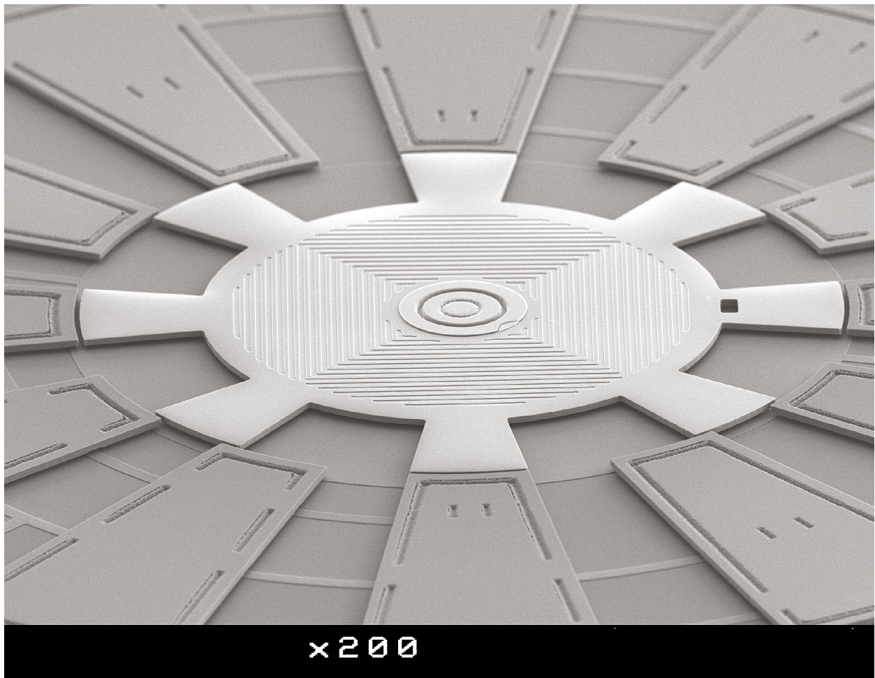
Slika 3.1. Polisilicijski mikromotor dobiven površinskim mikrooblikovanjem. [1]
