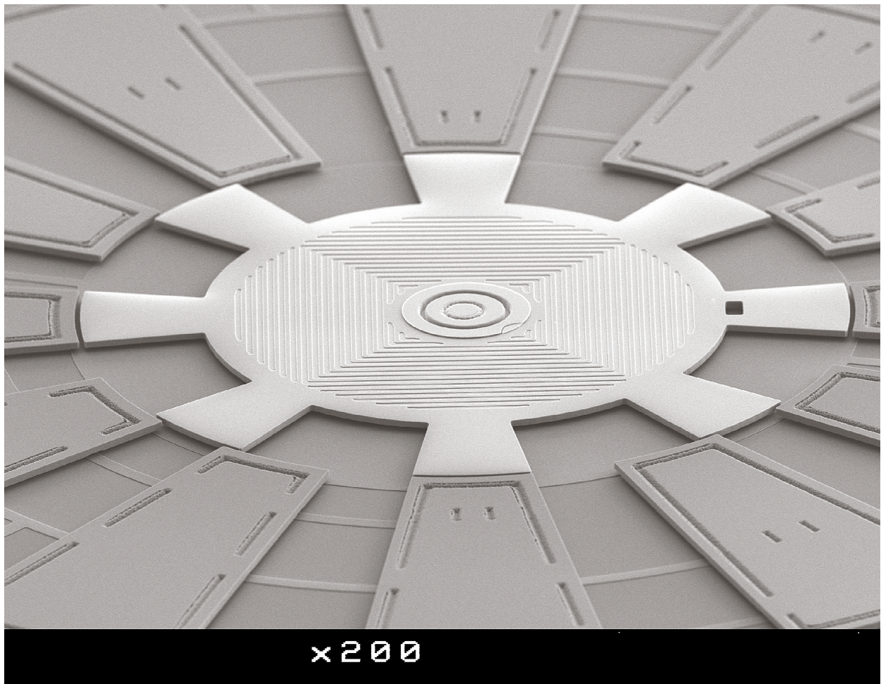
Slika 3.1. Polisilicijski mikromotor dobiven površinskim mikrooblikovanjem. [1]
