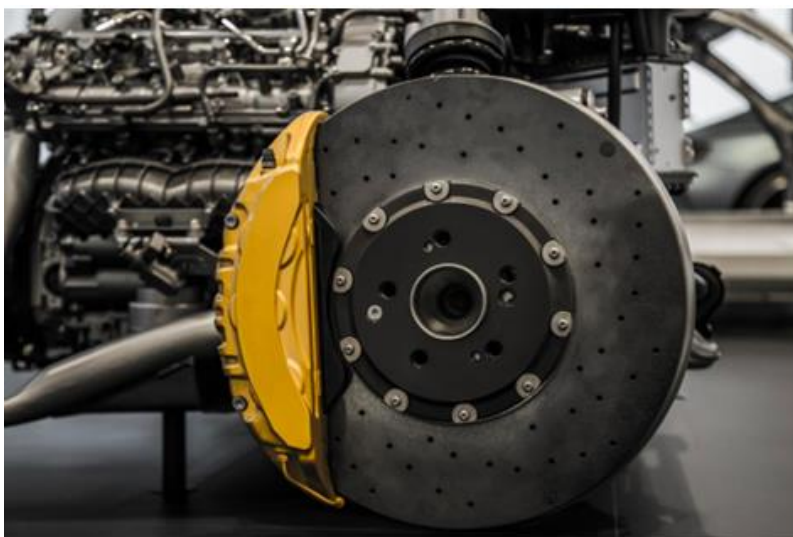
Slika 5. Keramički kompozitni disk [5]
