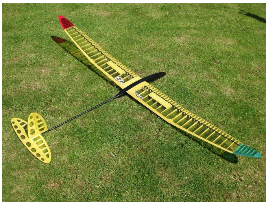
Slika 2.1. F3L jedrilica za termički let (model Eli) [2]
