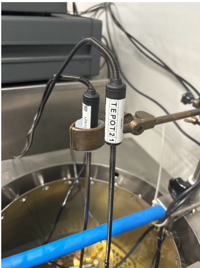
Slika 12. Otpornički osjetnici temperature
