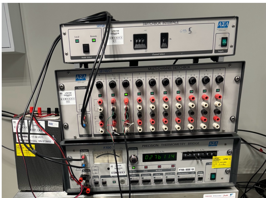
Slika 14. Instrumenti za mjerenje električnog otpora osjetnika temperature
