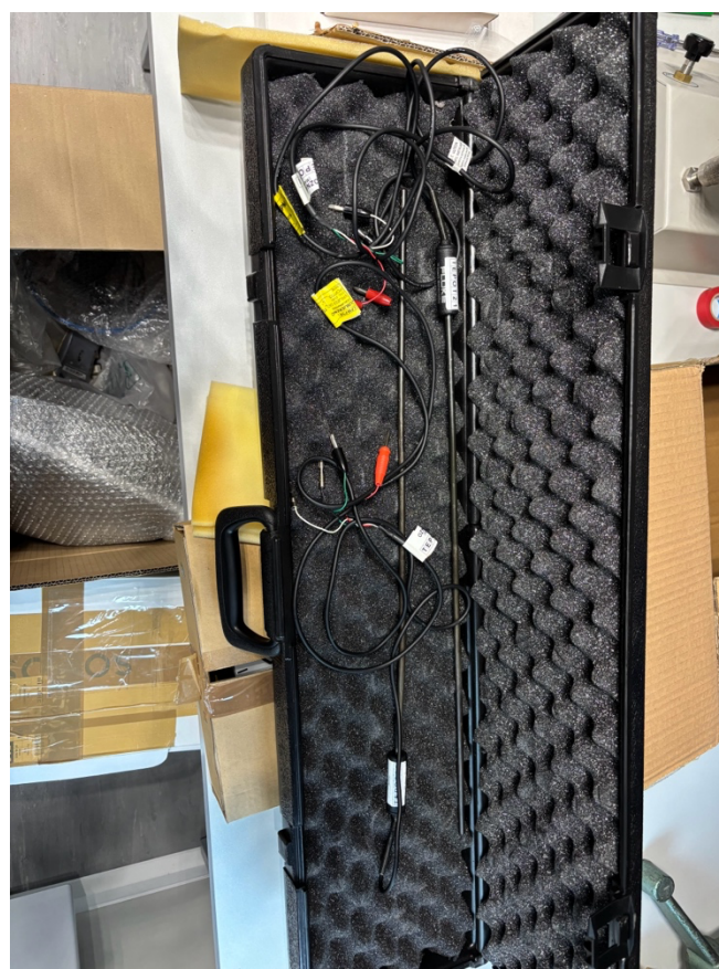
Slika 12. Otpornički osjetnici temperature
