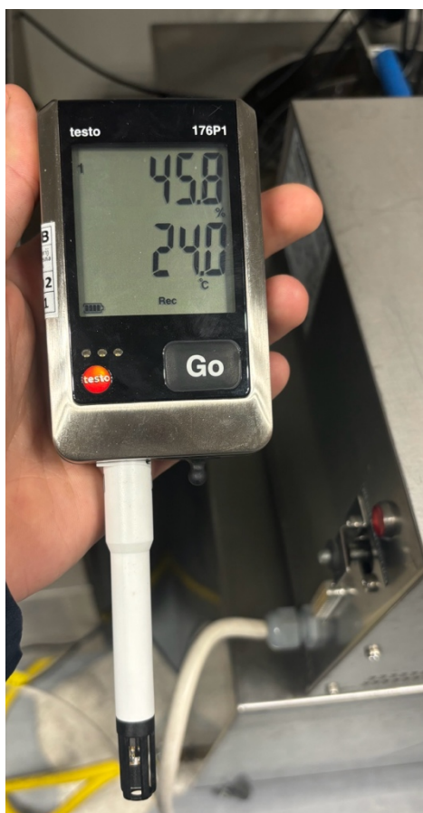
Slika 22. Uređaj za praćenje uvjeta okoline Testo 176P1
