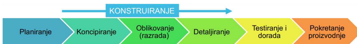
Slika 3.3.1. Faze razvoja proizvoda koje spadaju pod konstruiranje [6]
