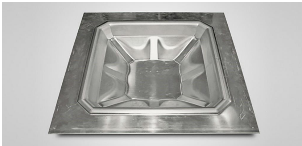
Slika 1. Proizvod izrađen postupkom inkrementalnog oblikovanja lima [1]
