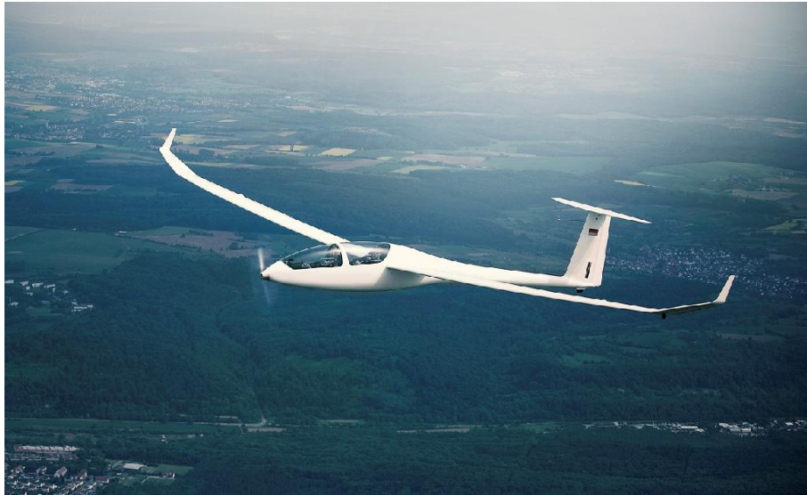
Slika 3.4. DG1001-e neo, prva dvosjedna jedrilica s FES-om [13]
