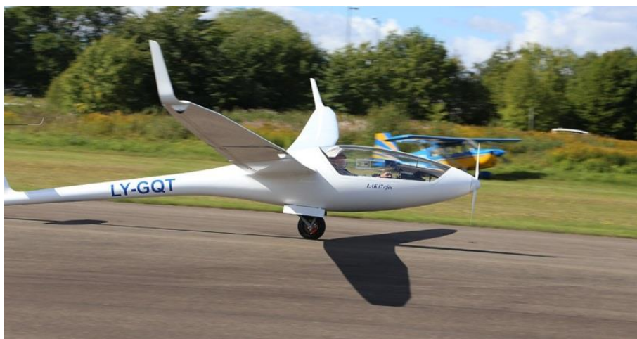
Slika 3.5. LAK17C FES, jedrilica FAI klase 15 m i 18 m [14]
