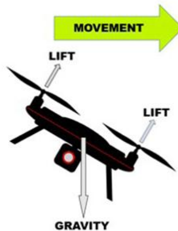
Slika 12. Sile pri horizontalnom letu [26]
