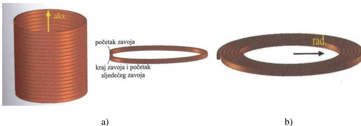
Slika 3. Namatanje: a) aksijalno i b) radijalno [3]
