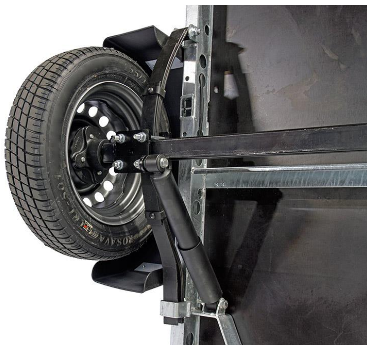
Slika 10. Ovjes sa lisnom oprugom [6]
