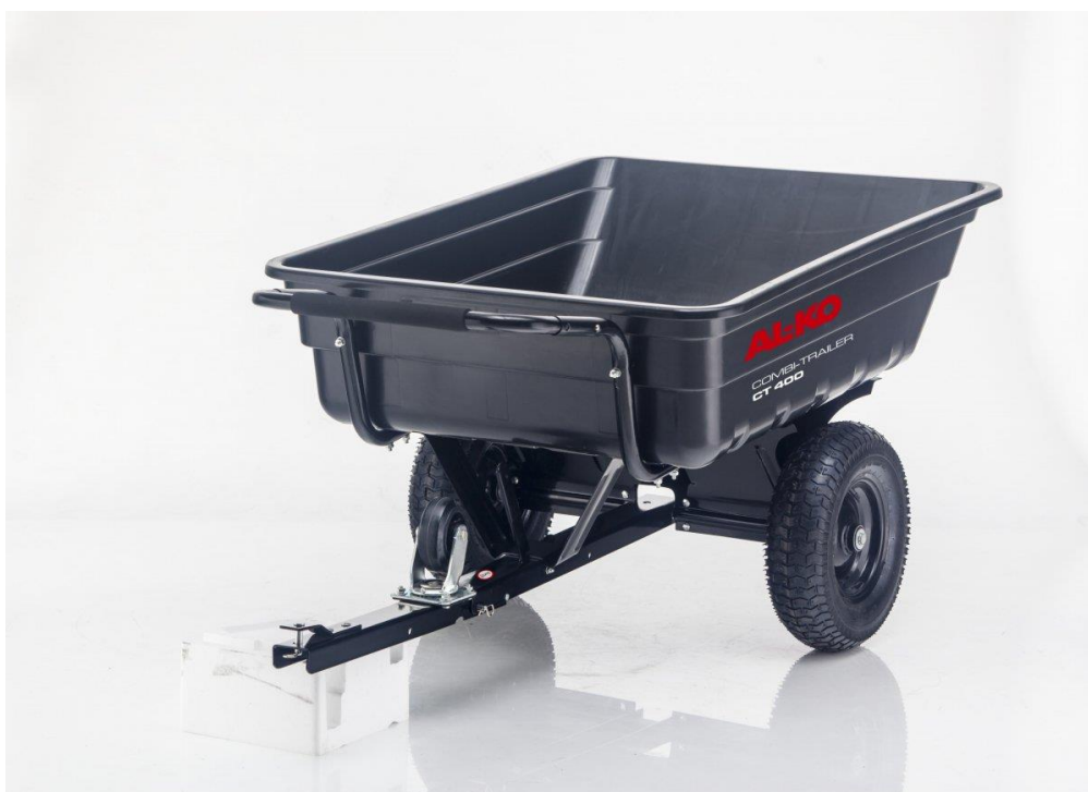
Slika 7. Polimerna izvedba teretnog sanduka [3]
