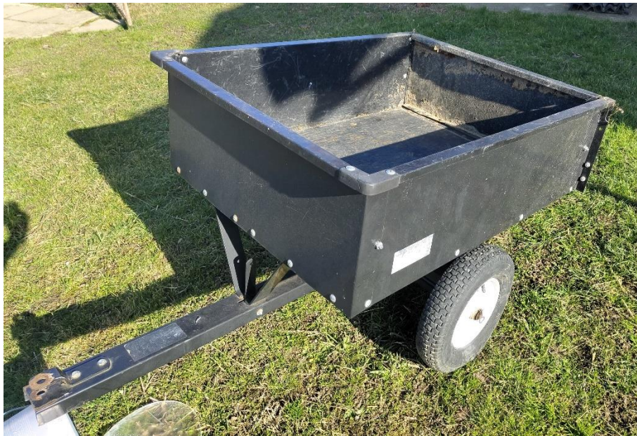
Slika 5. Klasična izvedba teretnog sanduka nakon više godina eksploatacije
