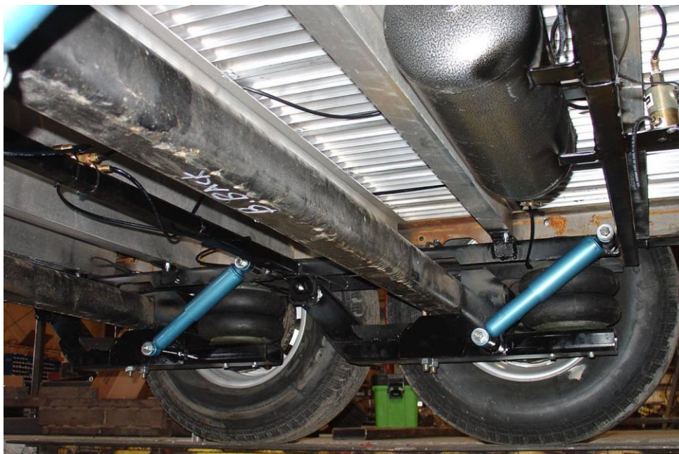
Slika 13. Primjer zračnog ovjesa na auto prikolici [8]
