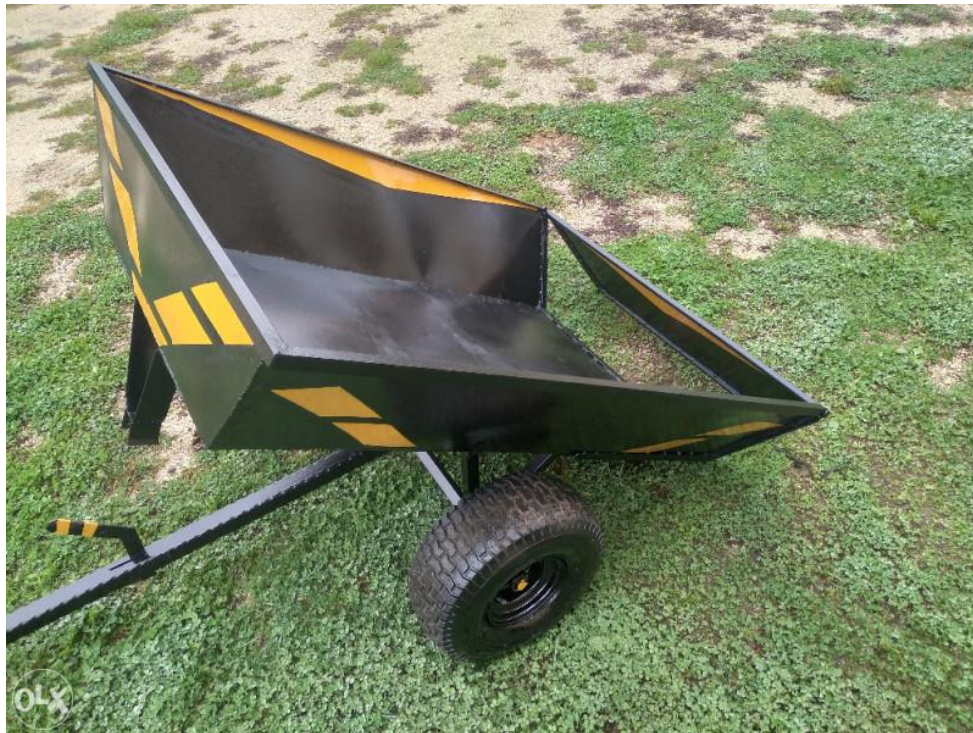
Slika 6. Zavarena izvedba teretnog sanduka
