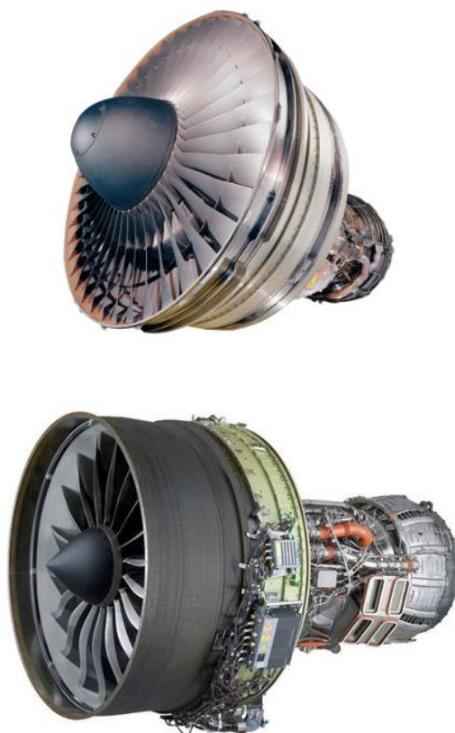
Slika 7. Usporedba motora Boeinga 747 - JT9D (gore) i GENx (dolje), Izvor: [16], [8]
