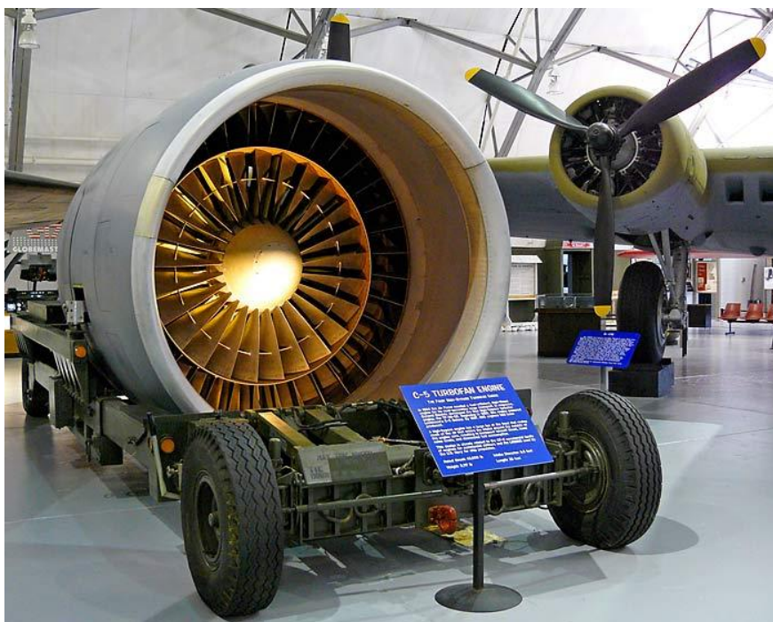
Slika 6. Prvi turboventilatorski motor s visokim bypass omjerom TF39, Izvor: [15]
