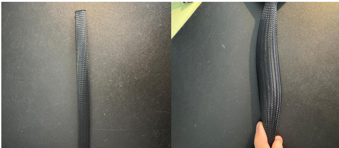
Slika 11. Flexo pletivo u skupljenom i opuštenom stanju
