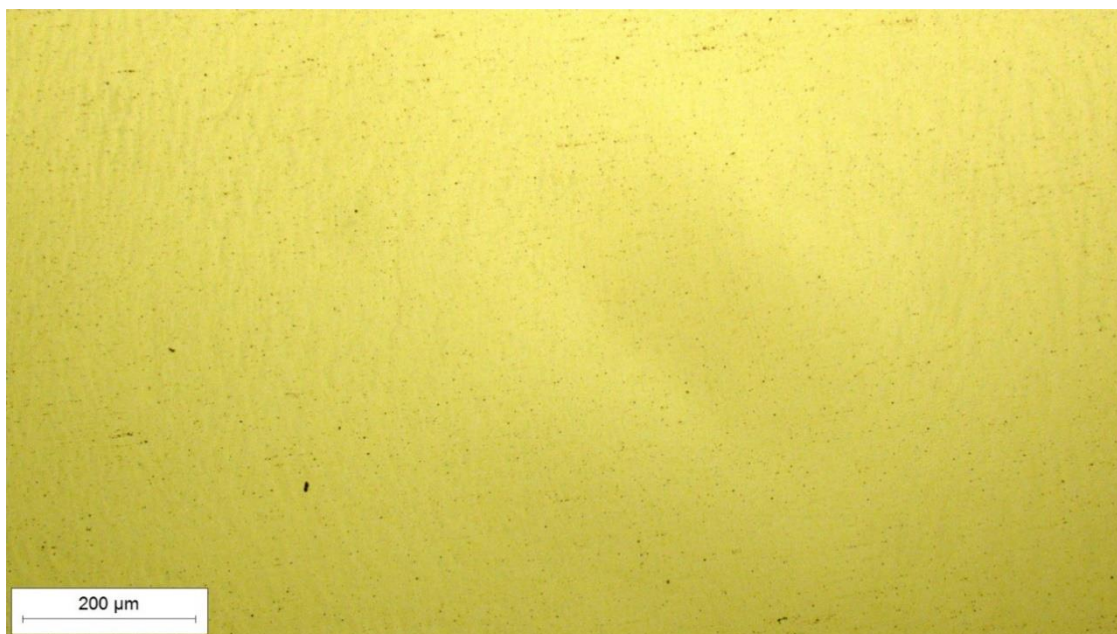
Slika 23. Mikrostruktura metala navara, snimljeno pri povećanju od 100×
