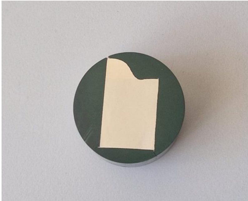
Slika 14. Metalografski uzorak nakon brušenja i poliranja površine
