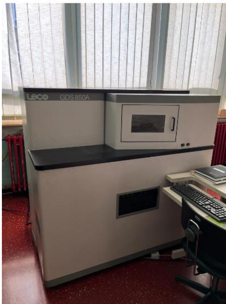
Slika 8. Uređaj za analizu kemijskog sastava GDS 850A-LECO
