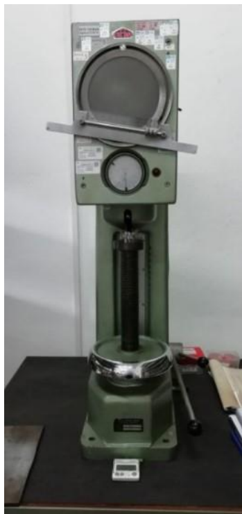
Slika 24. Uređaj za ispitivanje makrotvrdoće HV10
