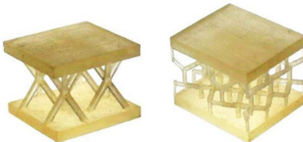
Slika 3. 3D printane konstrukcije napravljene od polipropilena, 3D Kagome (lijevo) i heksagonalna dijamantna konstrukcija (desno) [5]
