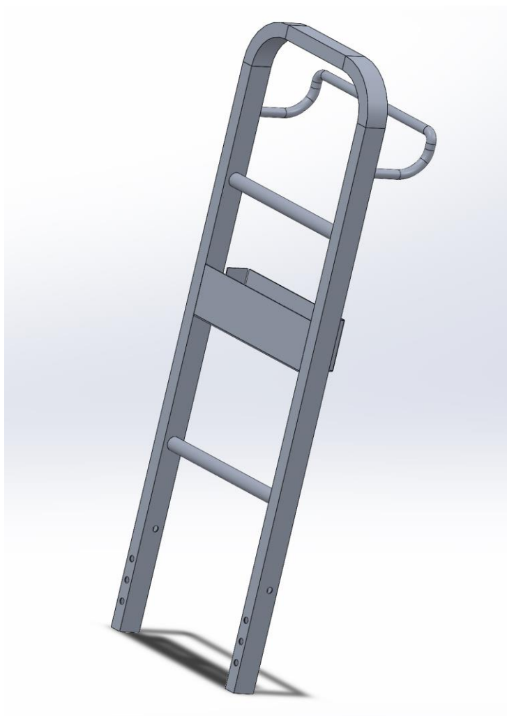
Slika 39. Zavareni podsklop konstrukcije
