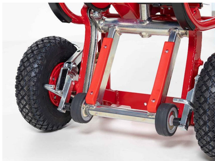
Slika 6. Mehanizam savladavanja stepenica
