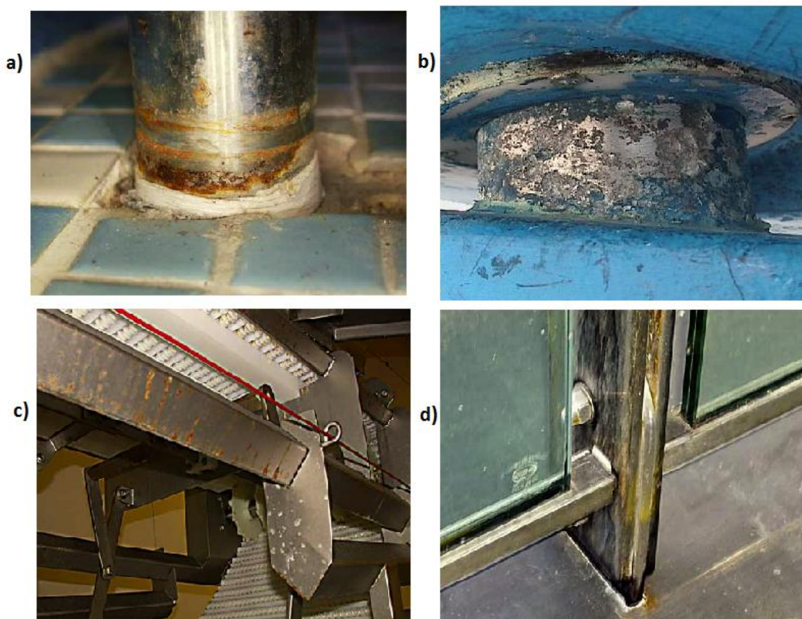
Slika 2. Korozija nehrđajućih čelika: a) korodiran rukohvat bazena; b) korodirana osovina kormila broda; c) korozija stroja u prehrambenoj industriji; d) korozija u arhitekturi [9, 10]
