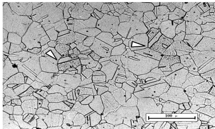
**Slika 6.** Mikrostruktura austenitnog nehrđajućeg čelika NF709 (25Cr20Ni) [23]
