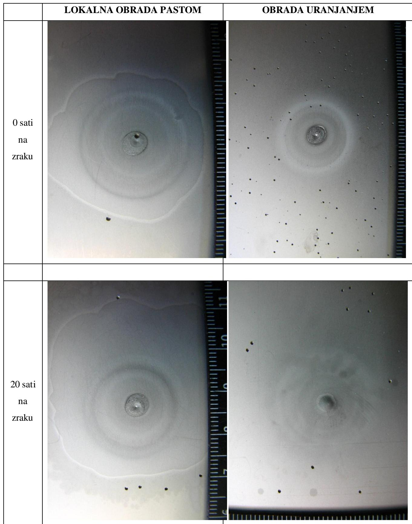
**Slika 34.** Detaljniji prikaz kemijski obrađenih uzoraka nakon koroziskog ispitivanja
