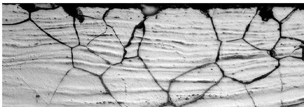
Slika 17. Makrostruktturna snimka interkristalne korozije [38]
