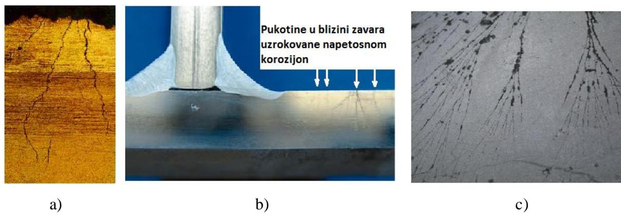
**Slika 18. Primjer napetosne korozije: a) makrostruktturna snimka transkristalne napetosne korozije, AISI 304L, kotao za dogrijavanje vode, nekoliko mjeseci; b) pukotine u blizini zavara uzrokovane zaostalim naprezanjima, AISI 304L; c) širenje pukotina na površini spremnika tople vode, AISI 304L, jedna godina [39, 40]**
