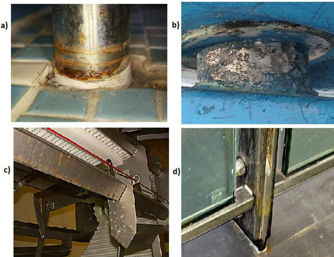
**Slika 2. Korozija nehrđajućih čelika:**
