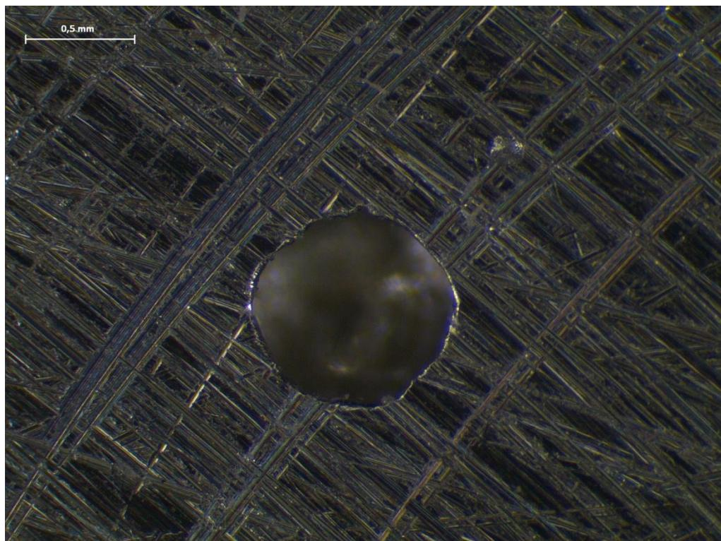
*MEHANIČKA OBRADA BRUSNIM DISKOM (O SATI NA ZRAKU)*
