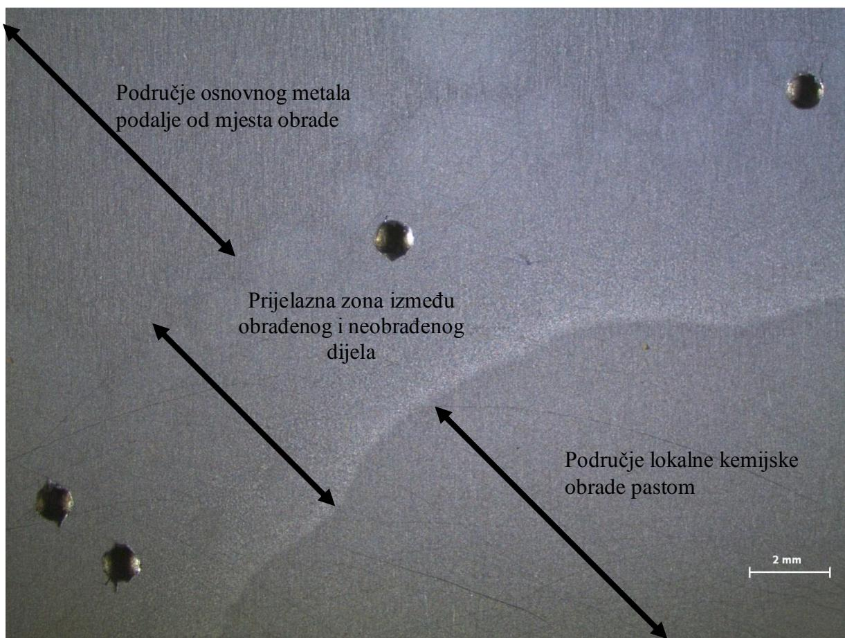
**Slika 35.** Stereomikroskopske snimke karakterističnih detalja uzoraka obrađenih kemijskom obradom pastom nakon koroziskog ispitivanja (gornja slika – 0 sati, donja slika – 20 sati).
