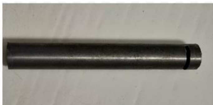
Slika 16. Izgled etalona prije kemijskog niklanja [14]
