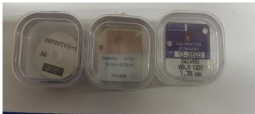
Slika 26. Etaloni korišteni za kalibraciju [9]
