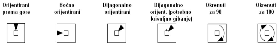
Slika 22. Osi izvlačenja dijelova pri rasklapanju
