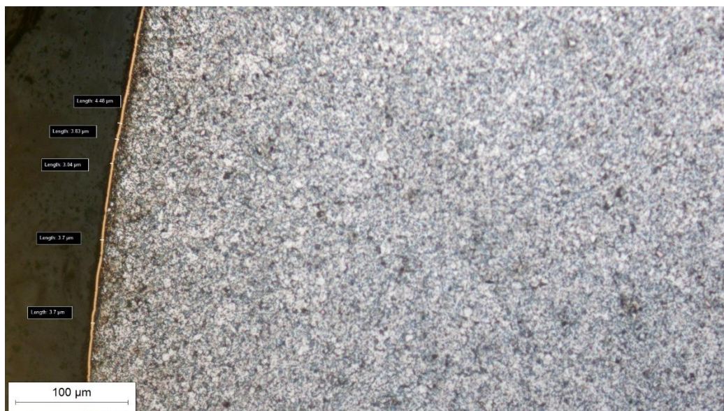
Slika 22: Debljina prevlake TiN/TiBN prevučene PACVD postupkom
