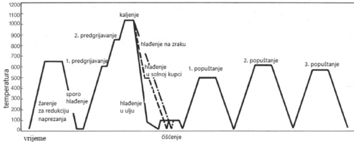
Slika 5: Toplinska obrada brzoreznih čelika [3]
