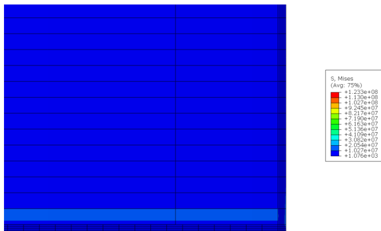
Slika 80. Uvećani detalj naprezanja dna na mreži s 8122 CAX8 elemenata u Pa
