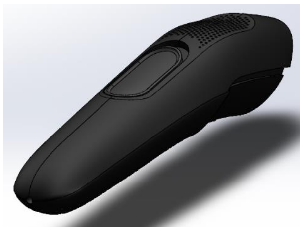
Slika 1180. Odvajanje dijela tijela brijača Još se za kraj stvara skošenje na kraju tijela brijača.
