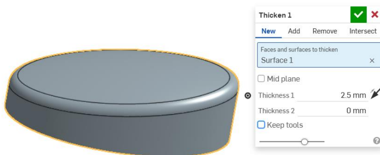
Slika 62. Zadebljanje površine od 2,5 mm
