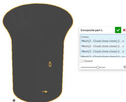
Slika 75. Kreiranje jedinstvenog krutog tijela alatom Composite part
