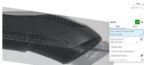
Slika 1180. Odvajanje dijela tijela brijača Još se za kraj stvara skošenje na kraju tijela brijača.
