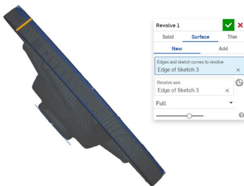
Slika 1259. Izrada prve površine naredbom Revolve
