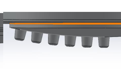
Slika 553. 6 otvora jednako udaljenih na krivulji
