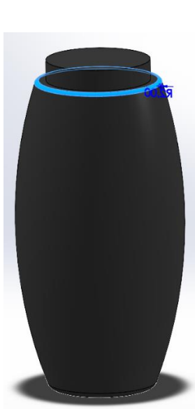
Slika 456. Zaobljenje od 2 mm
