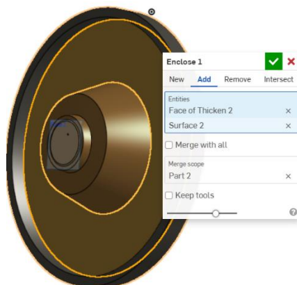
Slika 1263. Spajanje i pretvaranje površine u kruto tijelo
