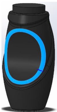
Slika 477. Zaobljenje radijusa 6 mm
