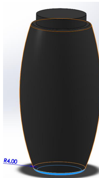
Slika 457. Zaobljenje od 4 mm
