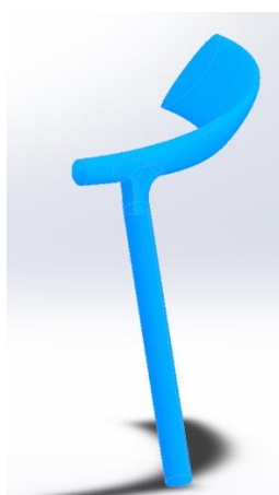
Slika 644. Spajanje površina Isti postupak se primjenjuje i sa suprotne strane stolice. Po stvaranju površine, naredbom Surface knit se i ona pridružuje ostalim površinama, tvoreći jedinstvenu površinu.
