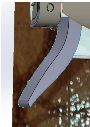
Slika 855. Površina dobivena naredbom Ruled surface
