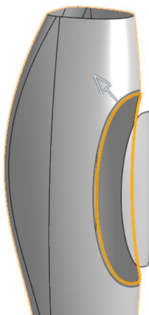
Slika 422. Pomicanje otvorenog ruba konzole
