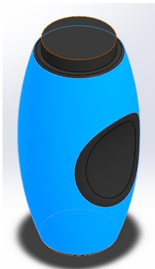
Slika 464. Ploha za stvaranje odmaknute površine
