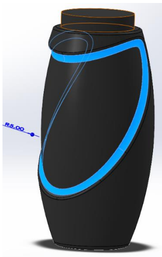
Slika 473 Zaobljenje unutarnjeg ruba od radijusa 5 mm
