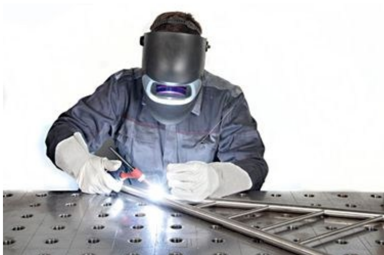
Slika 5. Desna tehnika rada pri zavarivanju [2].
