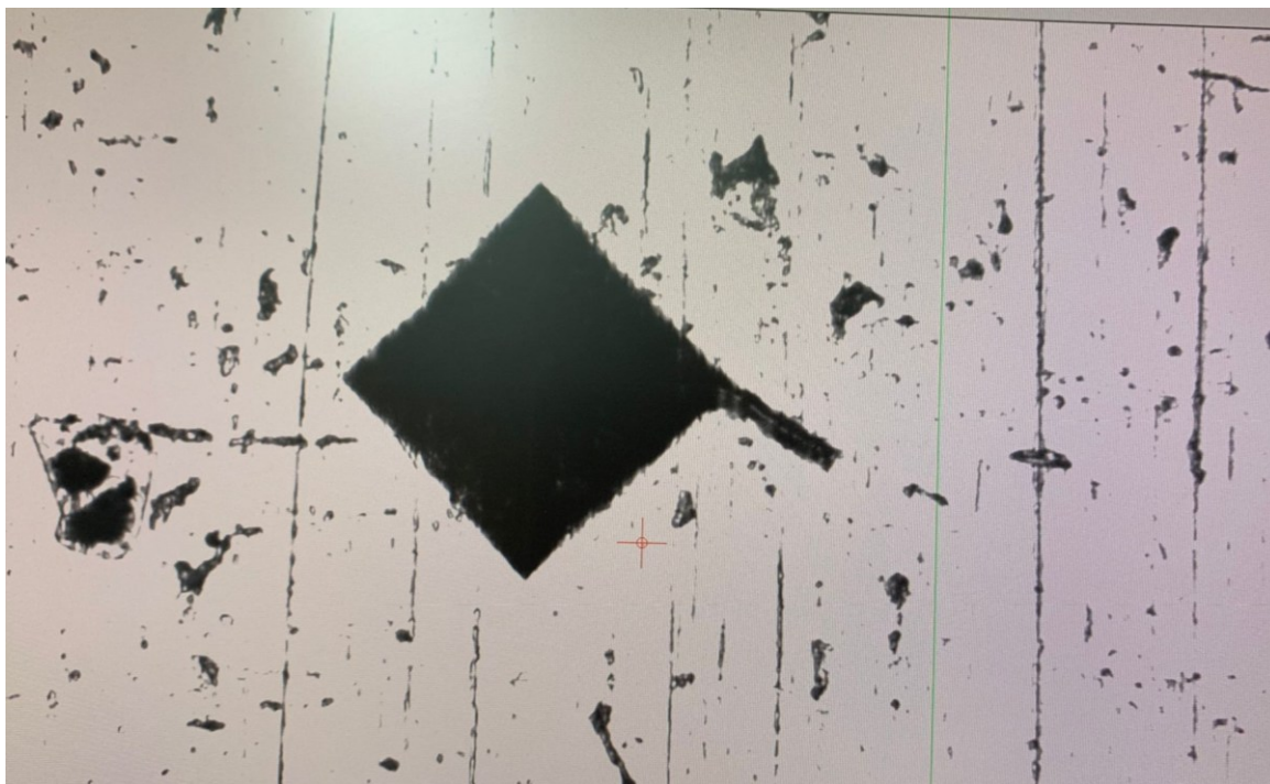
Slika 26. Otisak nakon ispitivanja tvrdoće HV1 koji je nastao tijekom mjerenja tvrdoće.
