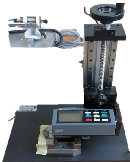
Slika 28. Uređaj (TIME 3202) i postolje (TIME A202) za ispitivanje hrapavosti površine
