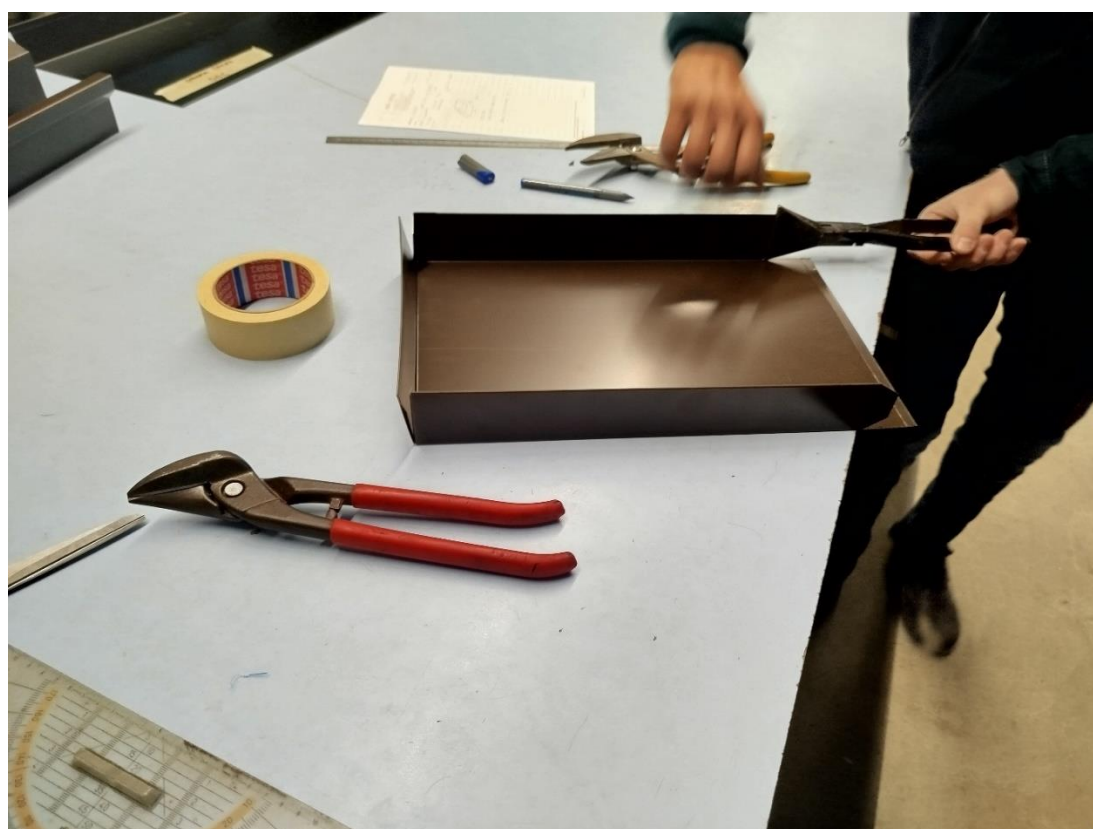
Slika 41. Ručno savijanje limenih peraca.
