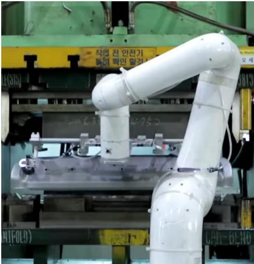
Slika 11. Automatska dostava materijala robotom.[11]
