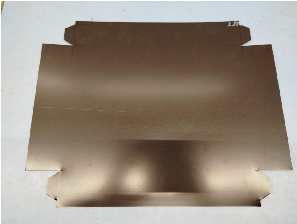
Slika 28. Lim nakon označavanja i predpripreme.
