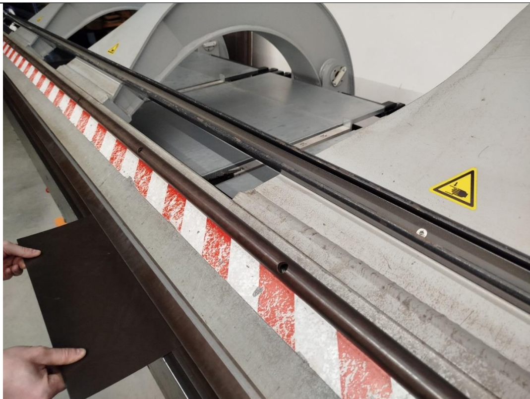
Slika 22. Umetanje lima u stroj za proces rezanja.
