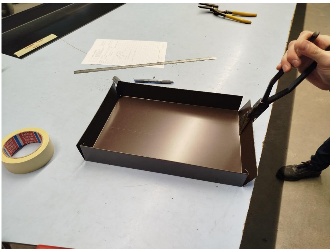
Slika 45. Ručno savijanje posljednje stranice do 90^\circ .
