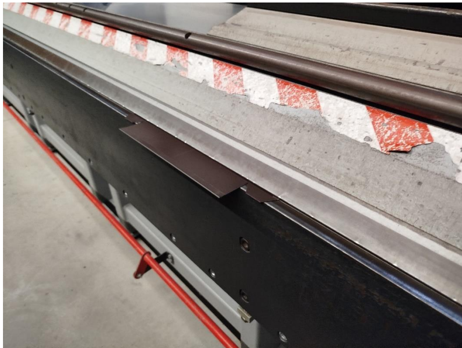
Slika 34. Stegnuta kraća stranica i perca ručnim pozicioniranjem na alat stroja.
