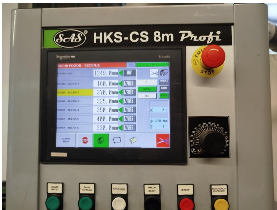
Slika 20. Podešavanje širine rezanja.
