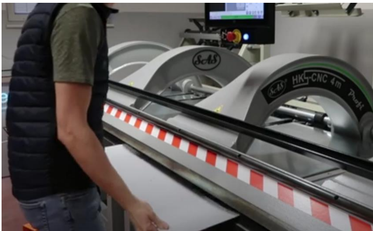
Slika 9. Ručna dostava materijala na alat.[9]
