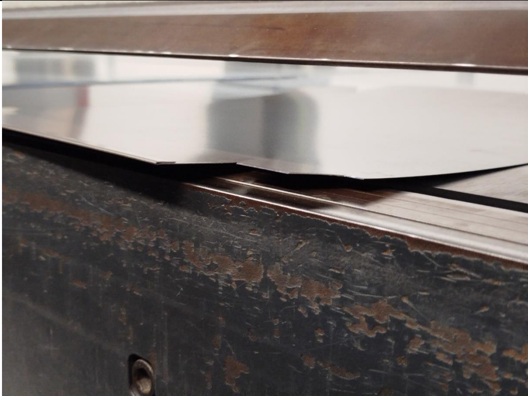
Slika 32. Lim nakon drugog koraka obrublivanja.
