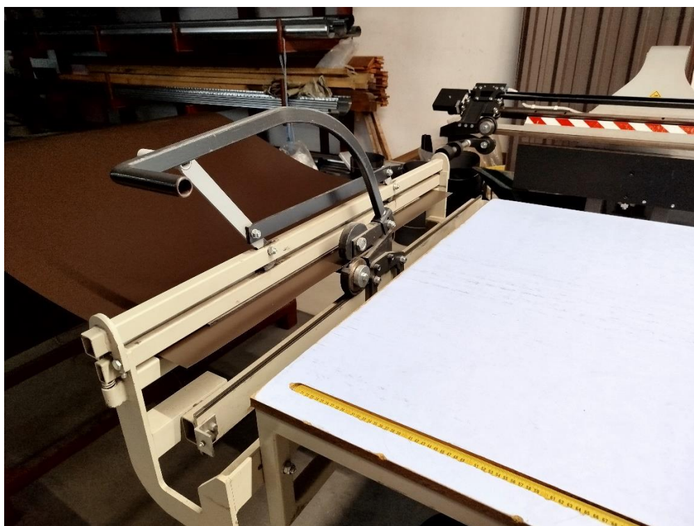
Slika 15. Škare za odrezivanje lima.
