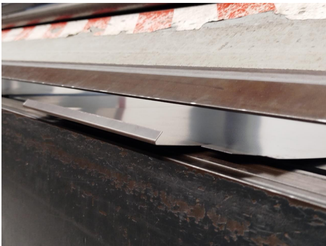
Slika 31. Pozicioniranje lima za drugi korak obrublivanja.
