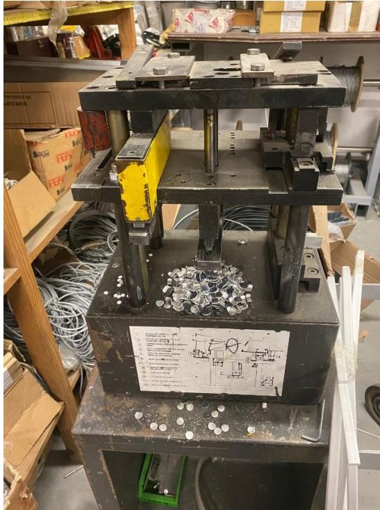
Slika 22. Štanca s vodećim stupovima – Feal
