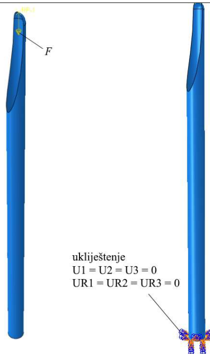
Slika 3.44 Rubni uvjeti i opterećenje trodimenzijskog modela stupa za slučaj najkritičnijeg načina opterećivanja
