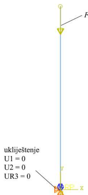
Slika 3.40 Rubni uvjeti i opterećenje jednodimenzijskog modela skupa za najkritičniji slučaj Rezultati proračuna prikazani su slikom 3.41.
