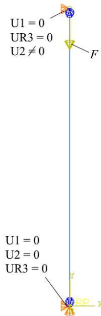
Slika 3.38 Rubni uvjeti i opterećenje jednodimenzijskog modela stupa
