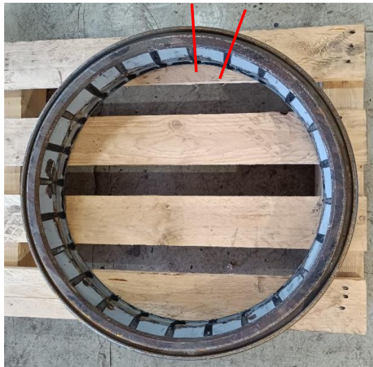
Slika 23. Obruč kotača tramvaja modela TMK 2300 i označeno mjesto rezanja obruča kotača
