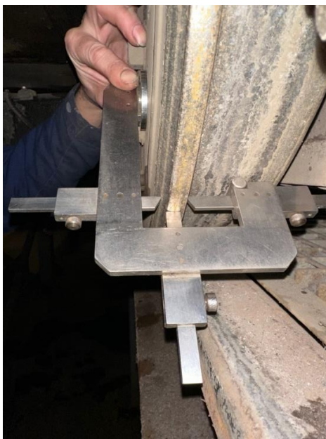
Slika 19. Mjerenje dimenzija profila kotača
