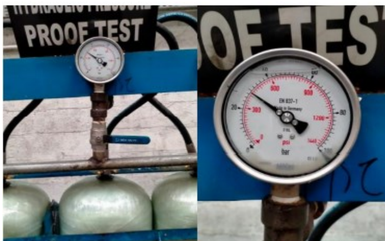
Slika 8. Hidrostatsko ispitivanje kompozitnog LPG tlačnog spremnika na 30 bar [9]
