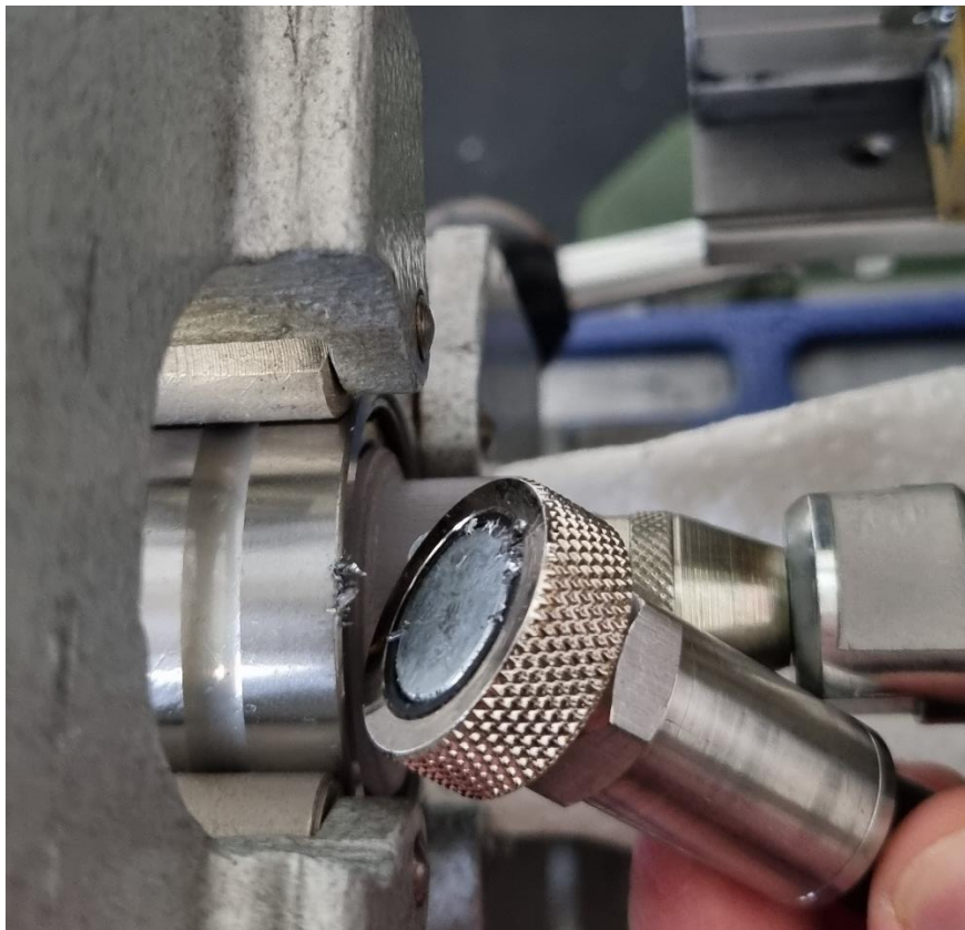
Slika 60. Čestice trošenja na sondi vibrometra nakon ispitivanja uzorka L3
