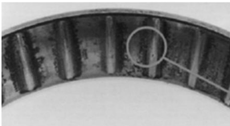
Slika 21. False brinellig kod igličastog ležaja [21]
