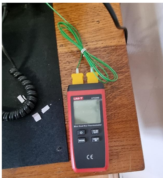
Slika 45. Uređaj UT-320D za mjerenje temperature ležaja
