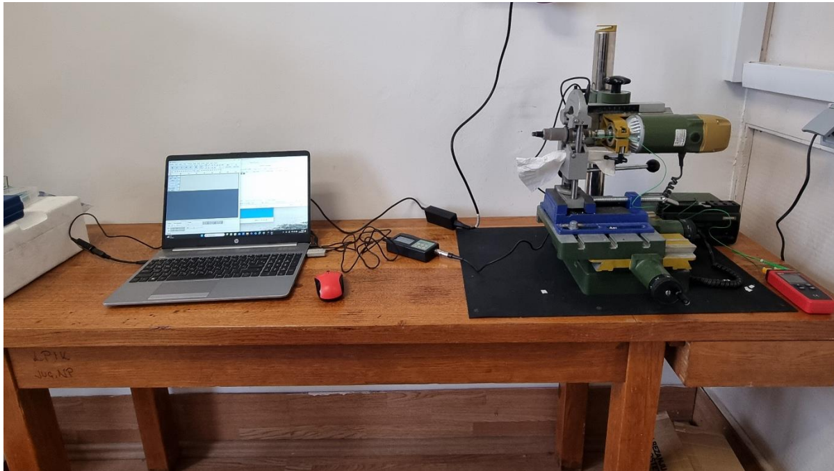
Slika 24. Mjerni postav za ispitivanje vibracija ležaja u praznom hodu.
