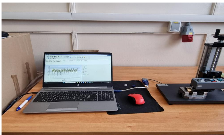
Slika 46. Mjerni postav za ispitivanje hrapavosti površine
