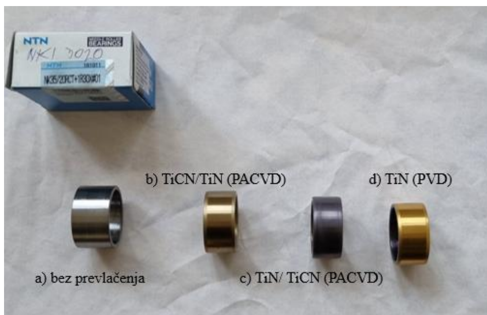
Slika 23. Uzorci unutrašnjeg prstena ležaja prije ispitivanja
