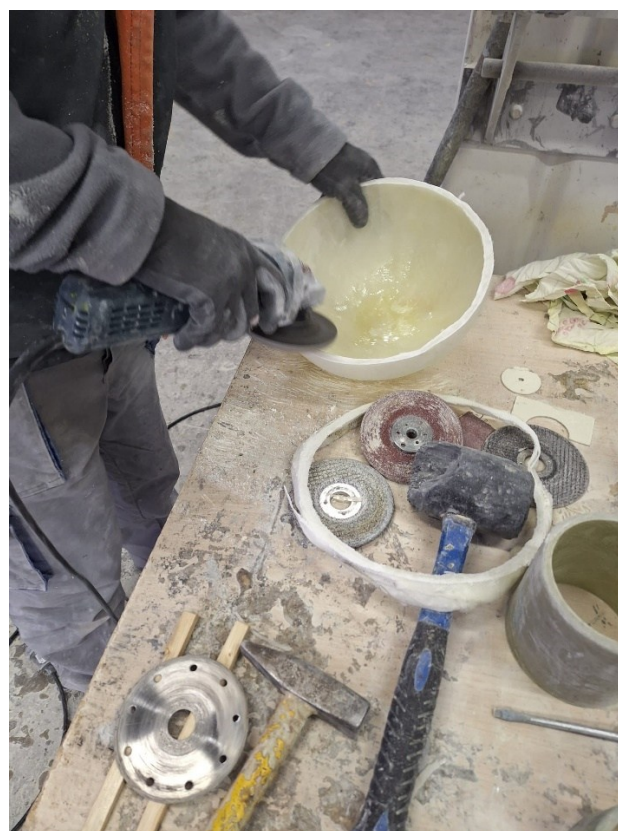
Slika 22. Rezanje i obrada treće kalote
