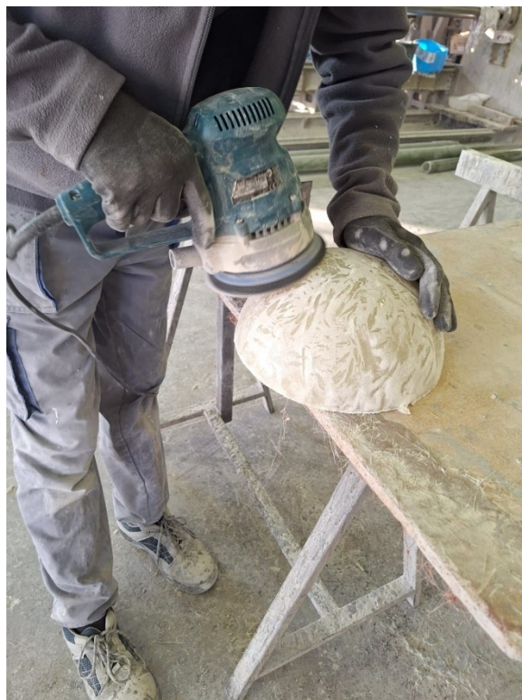
Slika 16. Površinska obrada prve kalote
