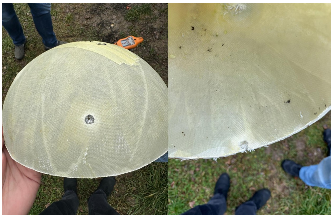
Slika 26. Vanjska i unutarnja strana prve kalote (.22 LR)
