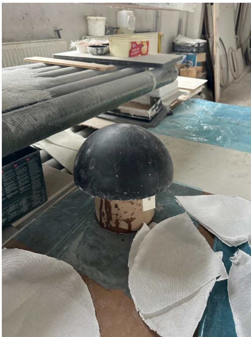
Slika 14. Kalup za prvu kalotu
