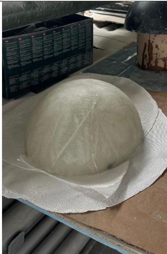
Slika 15. Prva kalota nakon izrade
