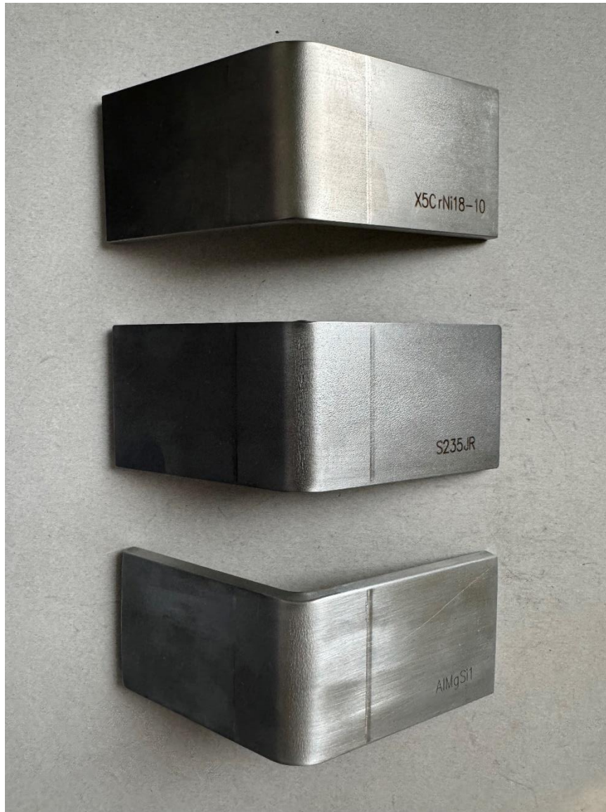
Slika 49. Ogrebotine uzrokovane matricom na savijenim komadima
