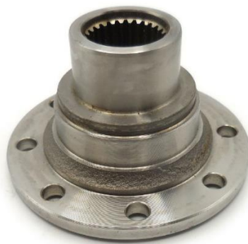
Slika 81. Prirubnica za kompenzaciju različite duljine pogonskih vratila [30.]
