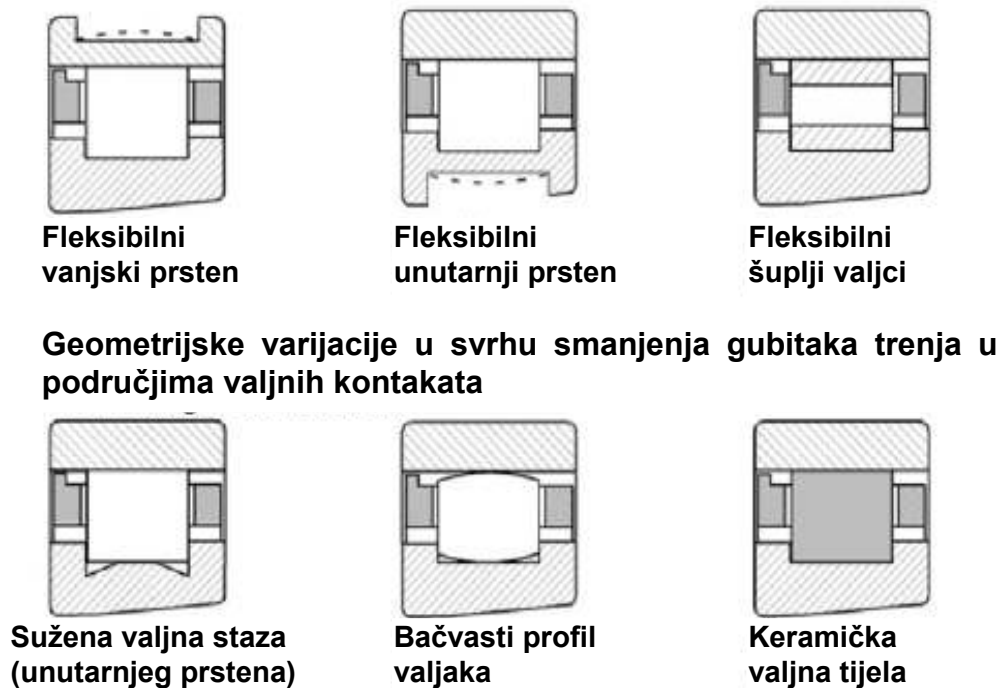
Slika 4.5. Konstruktivna rješenja ležajeva u svrhu smanjenja trenja [2]
